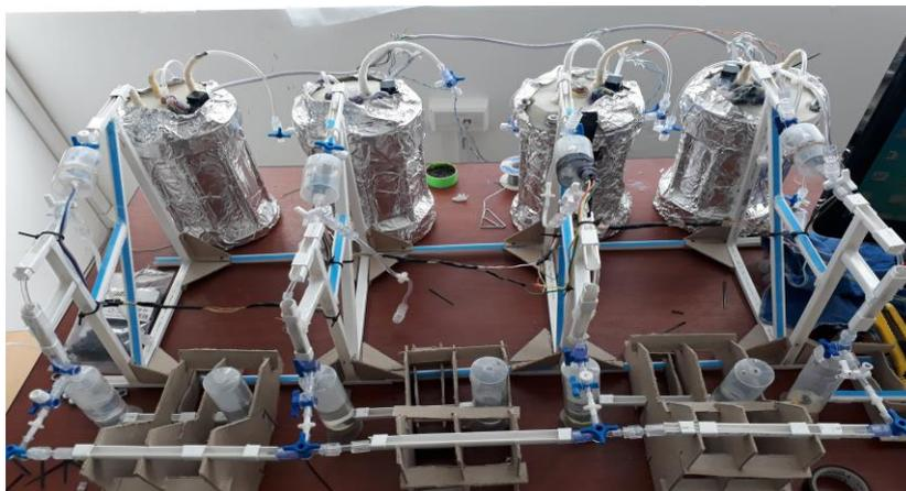
**Figura 16-2:** Reactores protegidos con papel aluminio y conectados a la placa ARDUINO UNO
