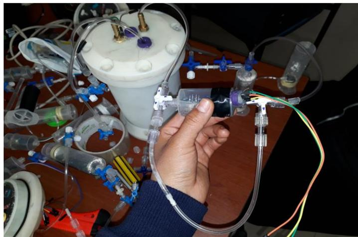
**Figura 8-2:** Cápsula con sensor externo de Hidrógeno
