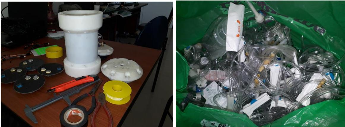
**Figura 4-2:** (a) Materiales empleados para el ensamblaje de tapas de los reactores (b) Equipos de venoclisis y válvulas usadas para el transporte de gases.
