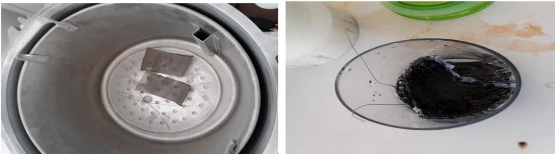
**Figura 12-2:** (a) Autoclavado de los electrodos (b) Electrodos sumergidos en solución de acetato de sodio
