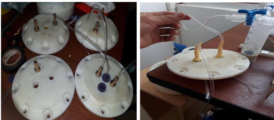
**Figura 5-2:** (a) Colocación de acoples de cobre tipo rosca y tapones de caucho en las tapas (b) Cubrimiento de acoples y mangueras con teflón y papel film
