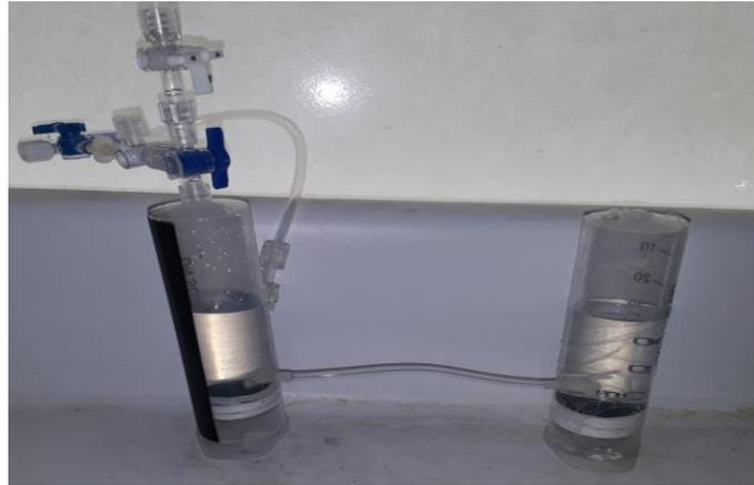
**Figura 7-2:** Sistema de descarga del gas Hidrógeno
