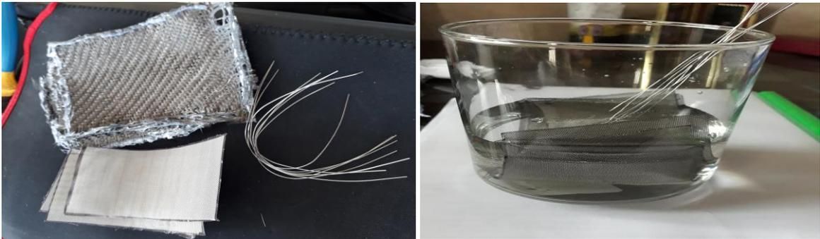
**Figura 11-2:** (a) Materiales usados para los electrodos (b) Electrodos sumergidos en agua destilada
