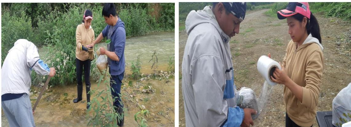
**Figura 3-2:**(a) Muestreo de lodos residuales en recipientes de vidrio y bolsas ziploc (b) Sellado de los recipientes con muestra para su transporte y análisis
