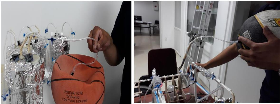
**Figura 17-2:** (a) Purgado de reactores con Nitrógeno (b) Purgado de la cápsula externa
