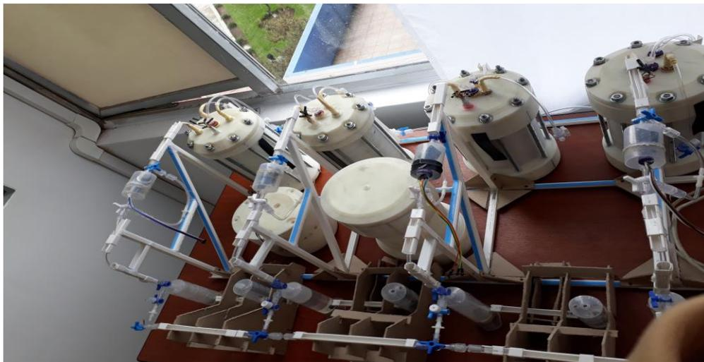
**Figura 9-2:** (a) Soporte de canaleta de plásticos para reactores y soporte de cartón para el sistema de descarga de gas
