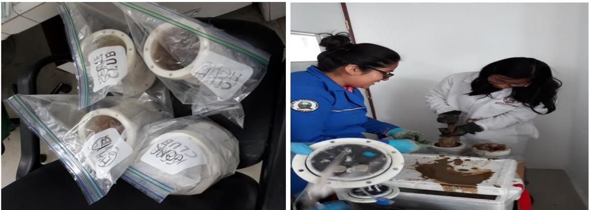
**Figura 10-2:** (a) Autoclavado de los reactores (b) Colocación de lodos en los reactores
