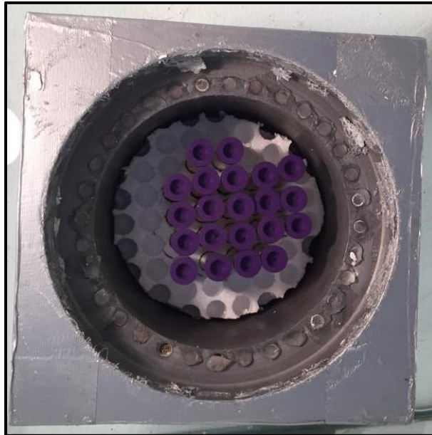
Figura 2-2: Configuración de los tubos de ensayo para la irradiación
