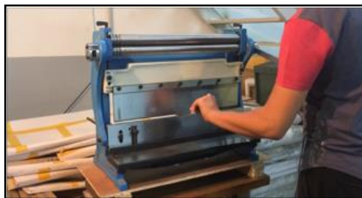
Figura 1-4. Corte de las chapas metálicas
