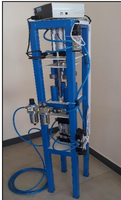
Figura 1-3. Condición inicial de la máquina briquetadora.
