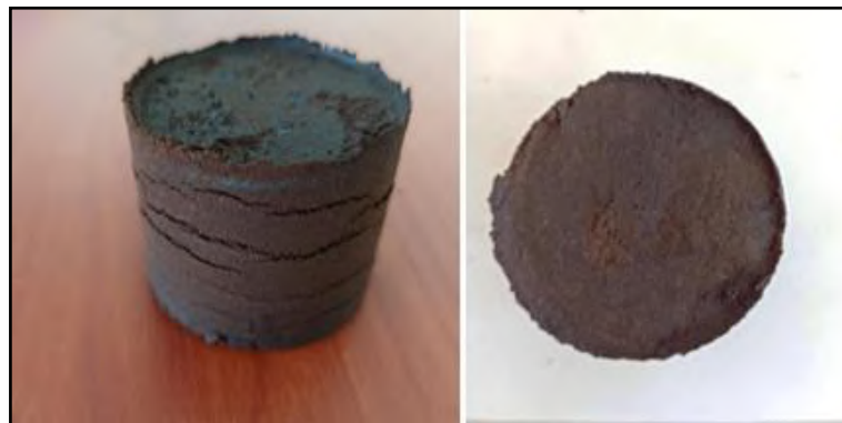
Figura 2-5. Briqueta de borra de café a 8 [Bar] y 120 [°C]
