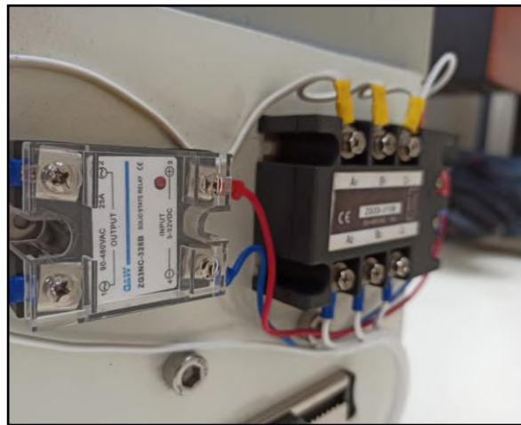
Figura 4-4. Conexión de los relés de estado sólido
