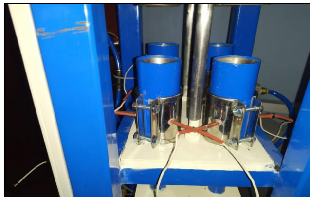
Figura 3-4. Disposición de las resistencias en la máquina
