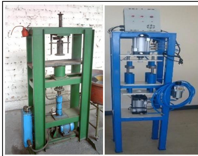
Figura 8-2. Prensa de pistón hidráulico y neumático.
