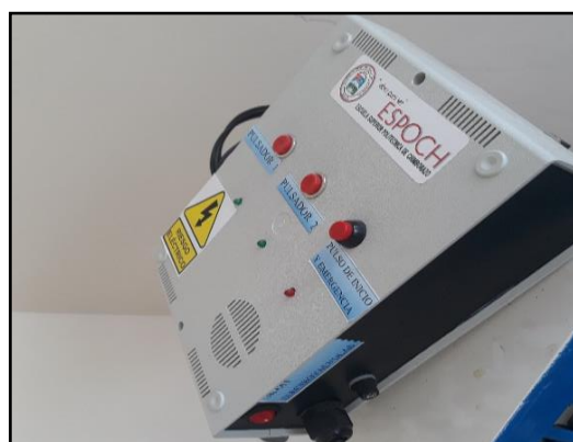
Figura 3-3. Cajetín con botonera para control de los cilindros neumáticos.
