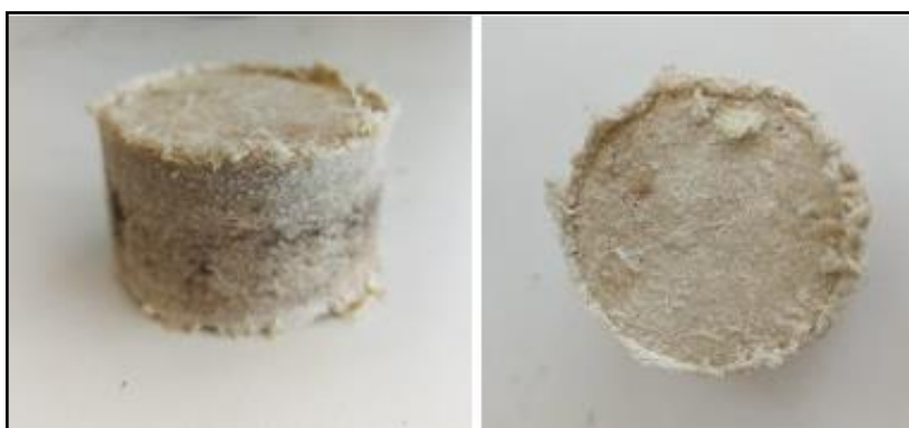
Figura 8-5. Briqueta de bagazo caña de azúcar a 4 [Bar] y 110 [°C]
