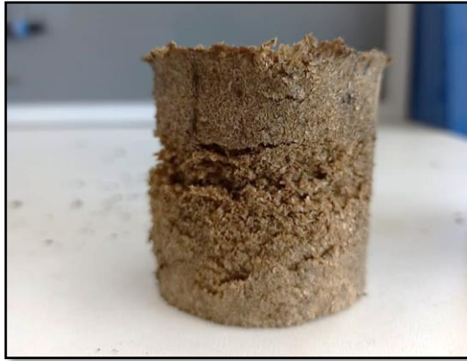
Figura 4-5. Briqueta de cascarilla de arroz a 4 [Bar] y 50 [°C]
