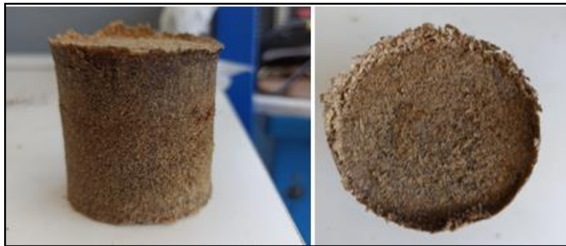
Figura 5-5. Briqueta de cascarilla de arroz a 6 [Bar] y 80 [°C]
