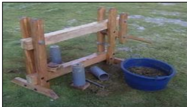
Figura 7-2. Máquina artesanal para fabricación de briquetas.
