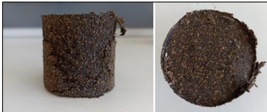
Figura 11-5. Briqueta de cascarilla de cebada a 4 [Bar] y 60 [°C]
