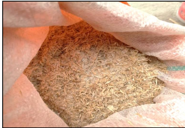
Figura 3-5. Cascarilla de arroz previo a molienda.
