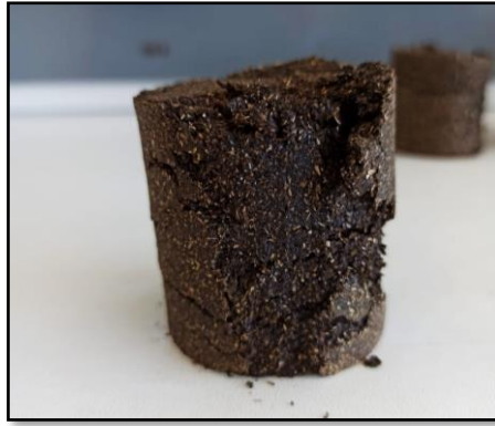
Figura 10-5. Briqueta de cascarilla de cebada a 3 [Bar] y 80 [°C]
