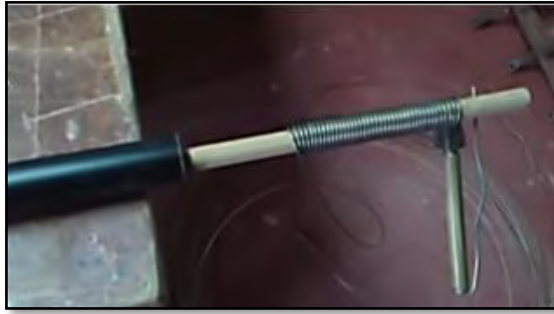
Figura 2-4. Bobinado del alambre de resistencia
