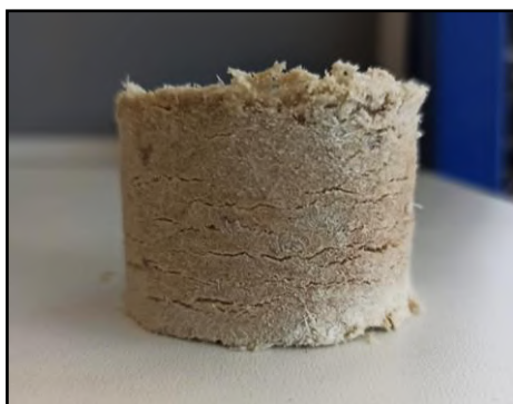
Figura 7-5. Briqueta de bagazo caña de azúcar a 3 [Bar] y 60 [°C]
