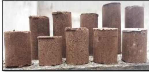
Figura 5-2. Secado de briquetas al aire libre.
