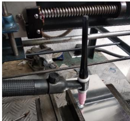
Figura 6-3: Montaje del equipo de soldadura y las placas de aluminio
