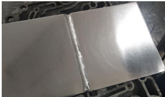
Figura 21-3: Junta soldada N°2
