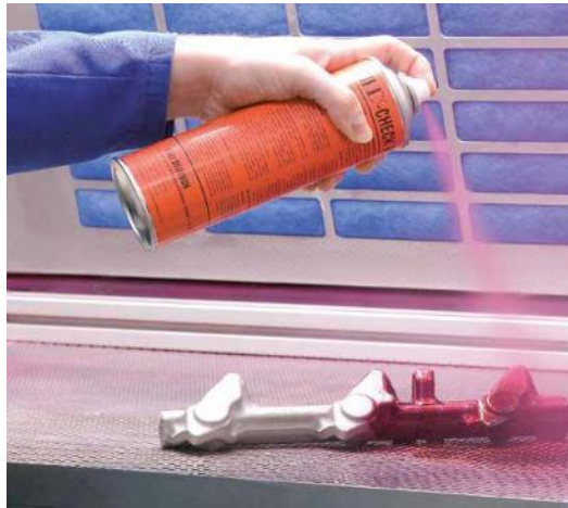
Figura 8-1: Ensayo de Líquidos Penetrantes en cordones de Soldadura
