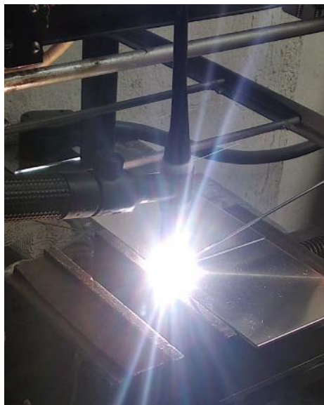
Figura 16-3: Montaje de las placas a soldar
