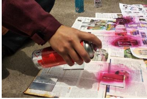
Figura 24-3: Aplicación del líquido penetrante Karl Deutsch
