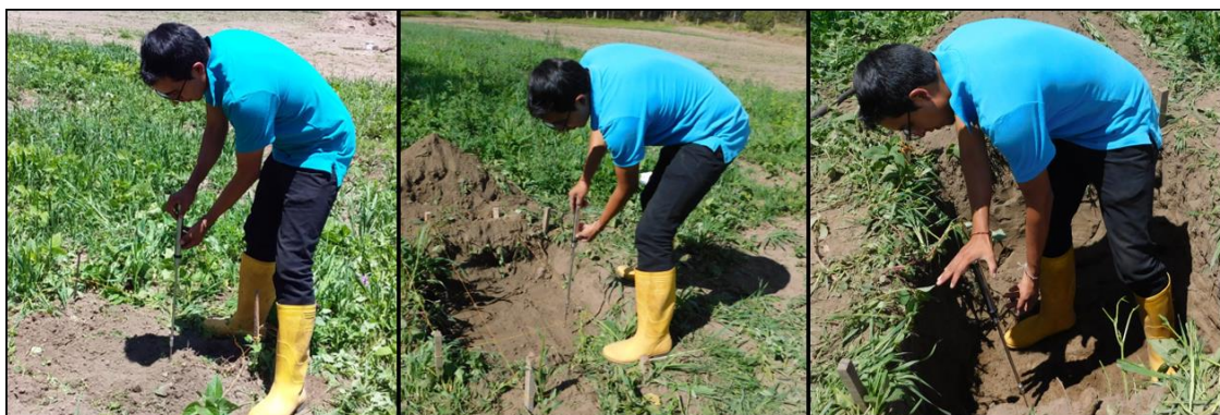
Figura 10. Lectura de compactación de capas de suelo.
