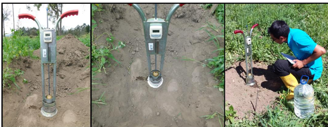
Figura 11. Prueba de infiltración en capas de suelo.
