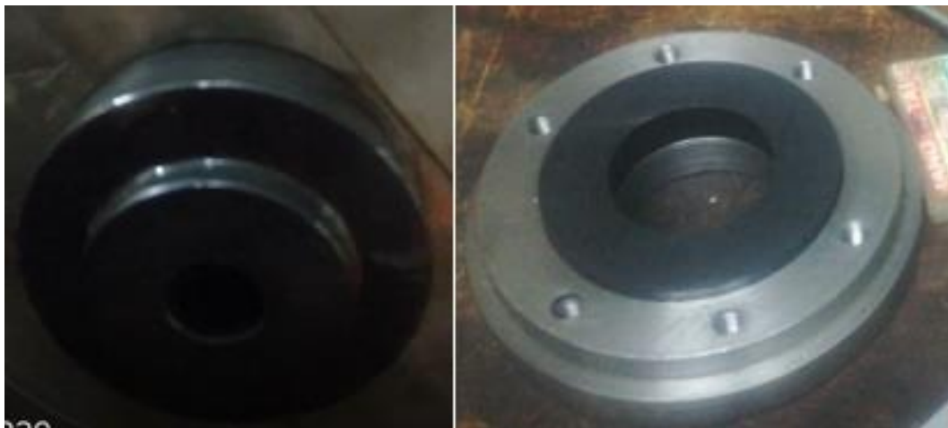
Figura 8-5 Placa matriz y punzón con tratamiento térmico de temple y revenido Realizado por: Jaramillo Javier, 2020
