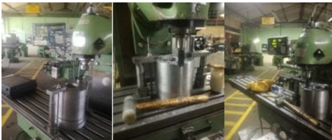
Figura 6-5 Construcción de ranuras y perforado para placa extractor guía-punzón en la fresadora. Realizado por: Jaramillo Javier, 2020
