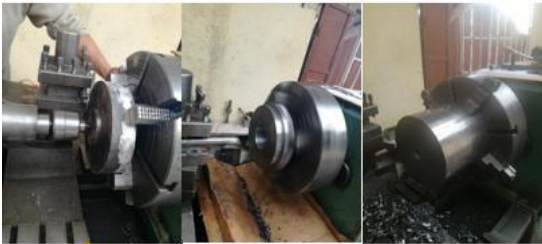
Figura 5-5 Construcción de placa base, placa matriz, punzón en el torno. Realizado por: Jaramillo Javier, 2020
