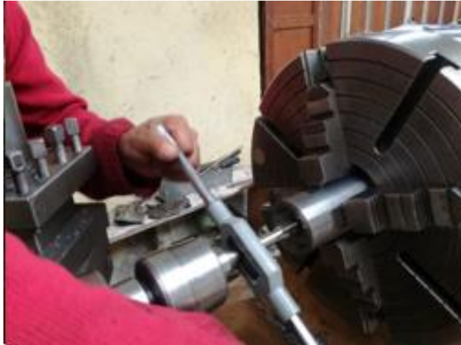
Figura 7-5 Roscado manual para el porta punzón. Realizado por: Jaramillo Javier, 2020
