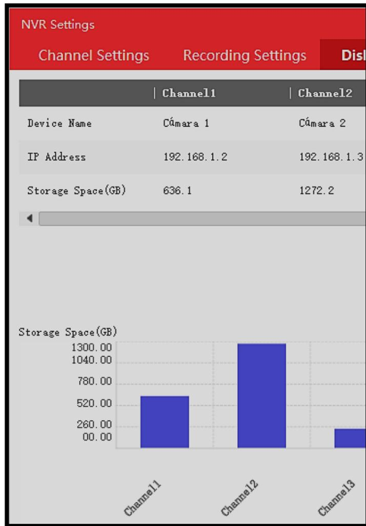
**Figura 8-4:** Espacio de almacenamiento del canal 1 utilizando H.265/HEVC y canal 2 utilizando H.264/AVC a 30 fps
