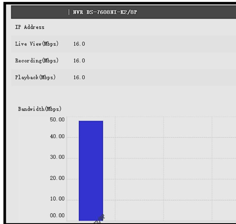
**Figura 13-4:** Ancho de banda utilizado por H.264/AVC a 15 fps
