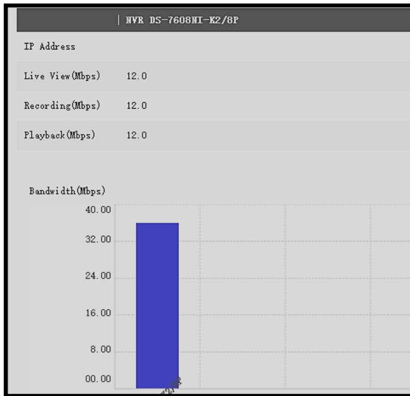
**Figura 15-4:** Ancho de banda utilizado por H.265/HEVC a 20 fps
