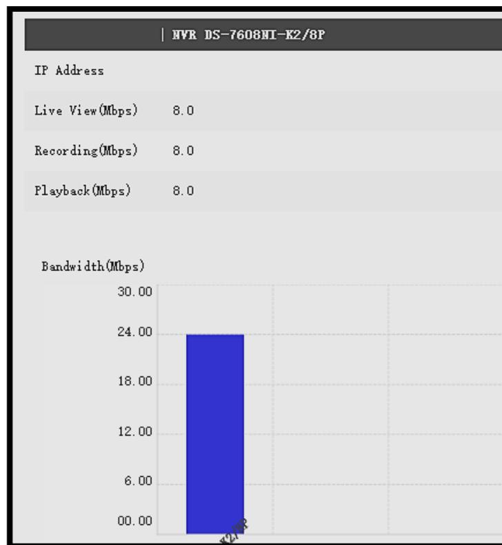
**Figura 11-4:** Ancho de banda utilizado por H.265/HEVC a 15 fps
