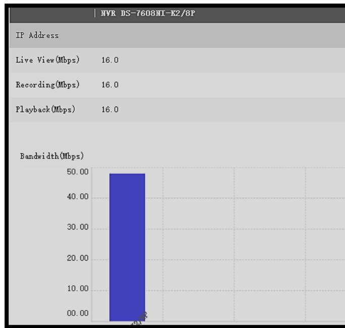
**Figura 23-4:** Ancho de banda utilizado por H.265/HEVC a 30 fps
