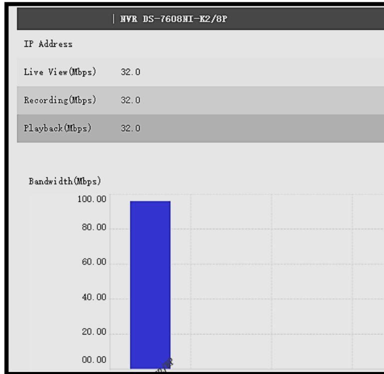
**Figura 27-4:** Ancho de banda utilizado por H.265/HEVC a 60 fps
