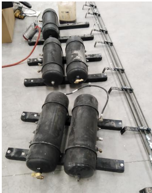
Figura 11-3. Accesorios desmontables del chasis
