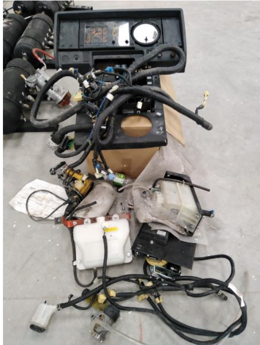
Figura 12-3. Elementos desmontables del chasis
