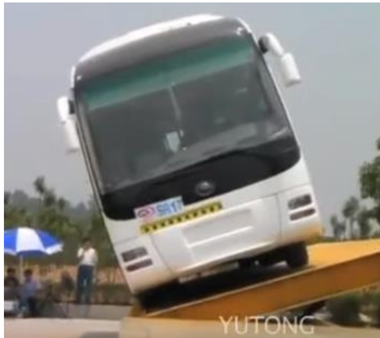
Figura 11-2. Ensayo de vuelco de autobús
