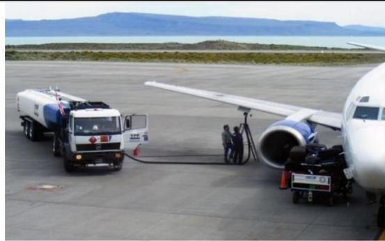
3. Se surte de combustible a los tanques de almacenamiento que posee la aeronave mediante equipos especializados.
