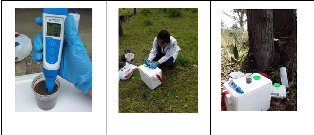
**Figura 2-2:** Medición de temperatura, pH, conductividad, TDS y salinidad en Situ
