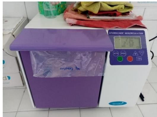
Homogenizado de muestras en equipo Stomacher
