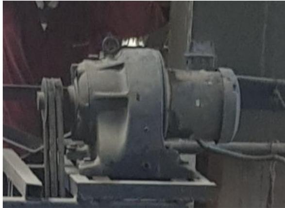
**Figura 31-3.** Motorreductor del movimiento longitudinal
