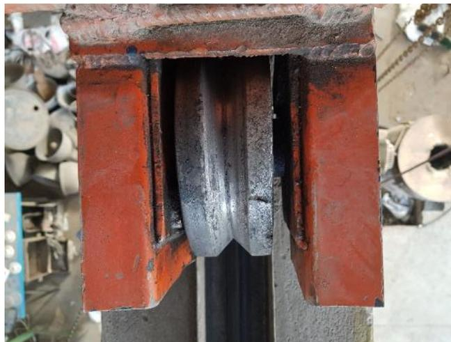
**Figura 5-4.** Rueda conducida del lado sur
