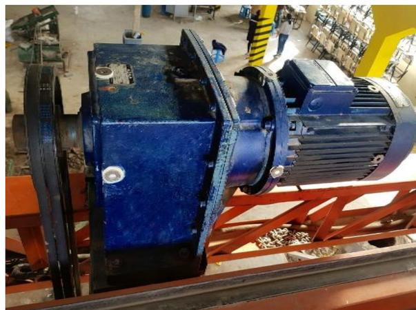
**Figura 30-4.** Motorreductor del movimiento transversal
