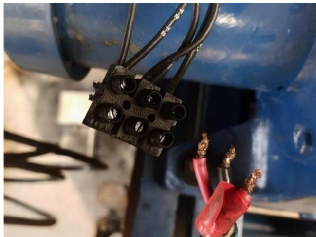
**Figura 26-4.** Borneras plásticas de unión
