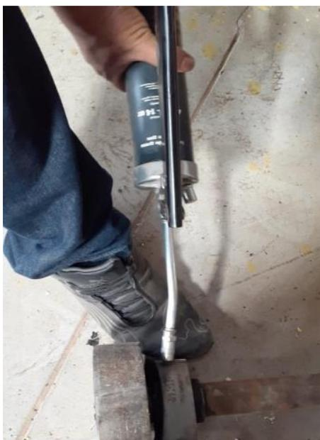
**Figura 12-4.** Relubricación de los rodamientos
