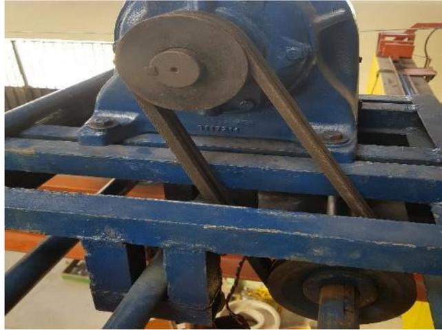
**Figura 13-4.** Conjunto de poleas del movimiento longitudinal
