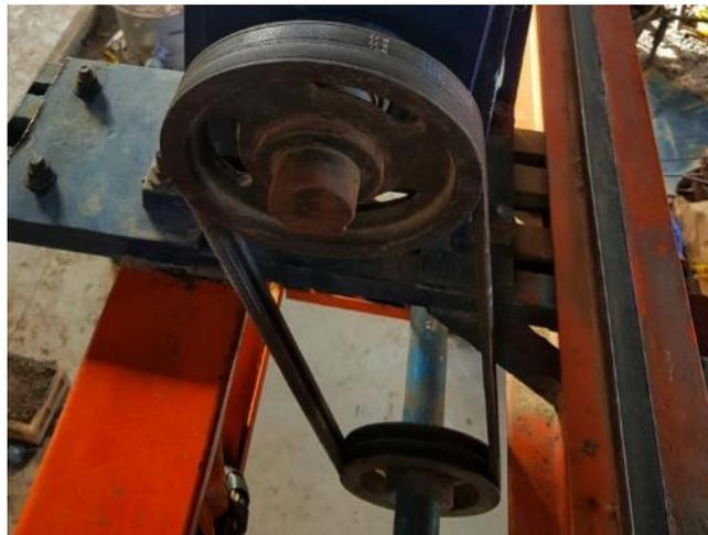
**Figura 14-4.** Conjunto de poleas del movimiento transversal
