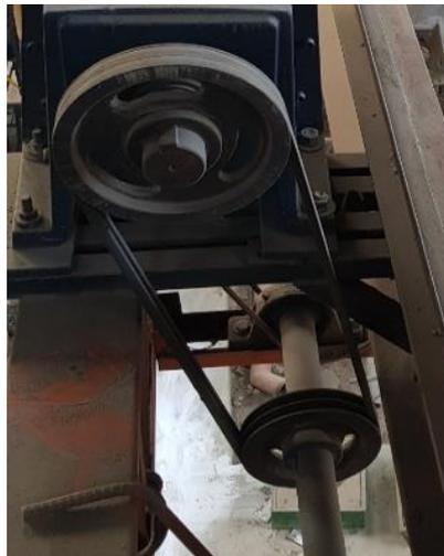
**Figura 16-3.** Conjunto de poleas del movimiento transversal
