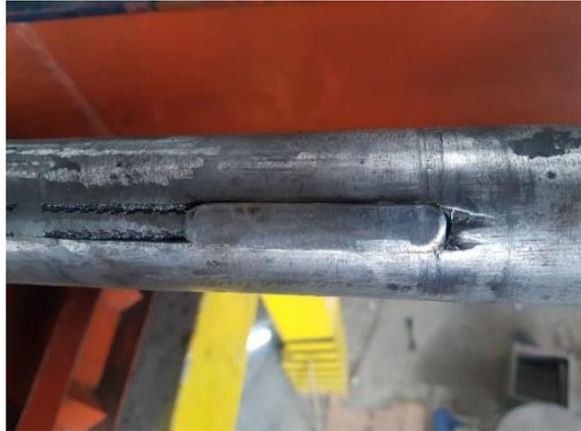
**Figura 10-4.** Chavetero y chaveta del lado sur del eje
