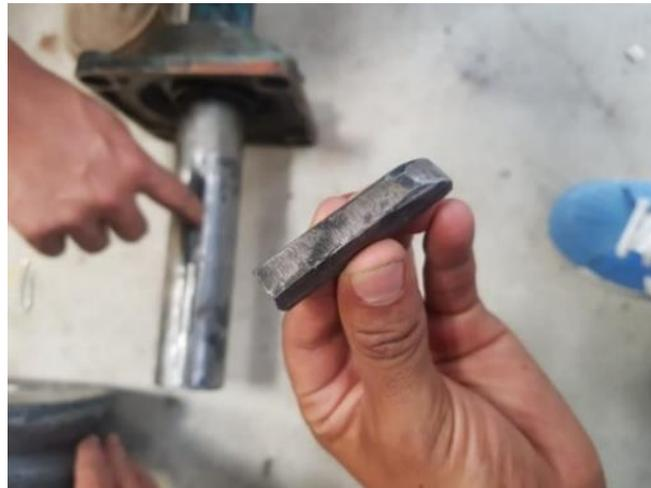
**Figura 13-3.** Chaveta del lado sur del eje
