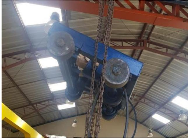
**Figura 17-4.** Carro metálico del movimiento longitudinal
