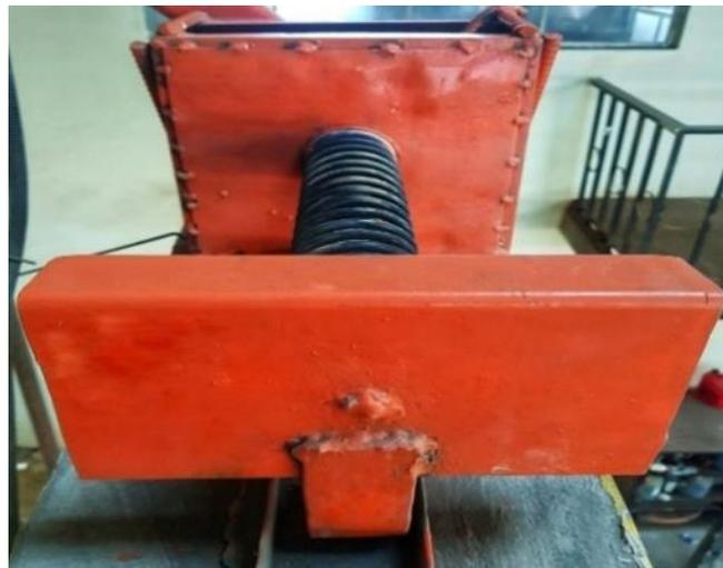
**Figura 18-4.** Amortiguador hidráulico del lado noroeste
