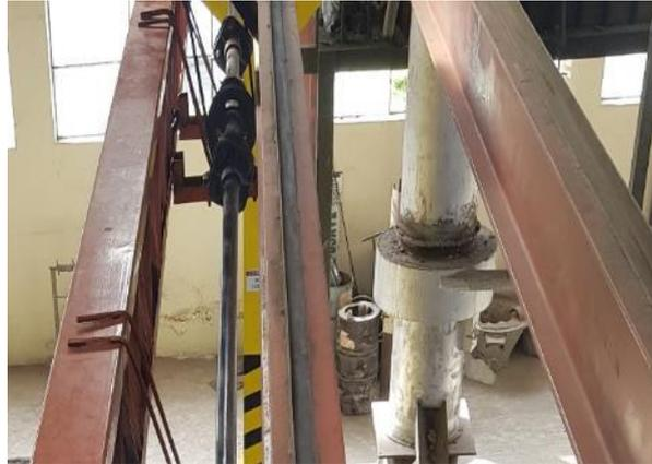
**Figura 2-4.** Vigas principales y auxiliar de metal
