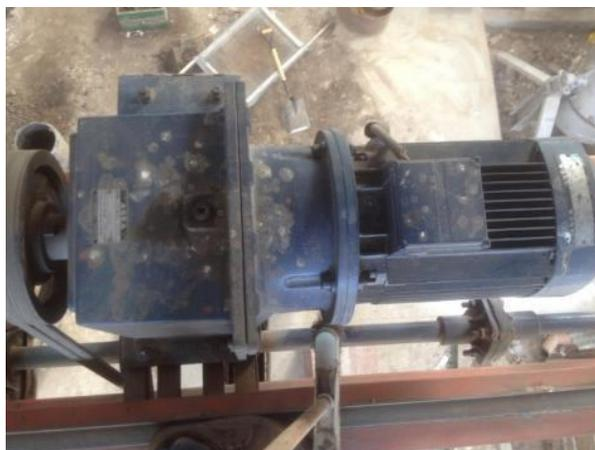
**Figura 32-3.** Motorreductor del movimiento transversal
