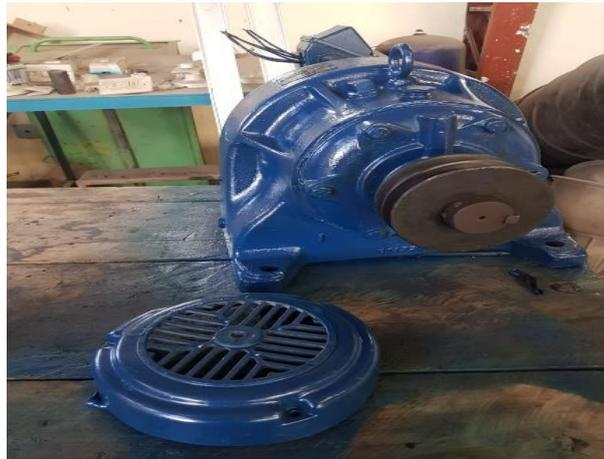
**Figura 29-4.** Motorreductor del movimiento longitudinal
