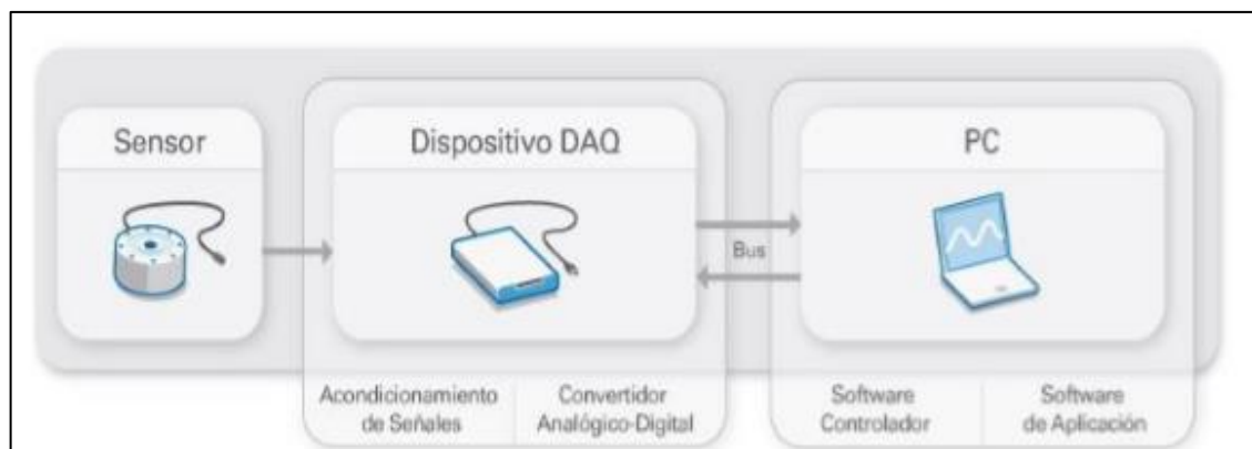
Figura 8-2. Acondicionamiento de señal con tarjeta de adquisición de datos.
