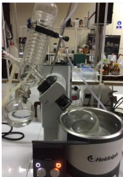
Concentración del extracto en el rotavapor
