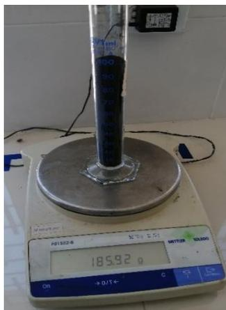
**Figura 16-2:** Densidad aparente del carbón físico
