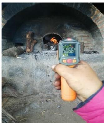
**Figura 11-2:** Activación química del mate a 506 °C
