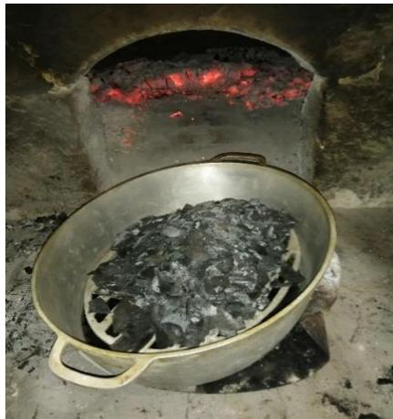
**Figura 9-2:** Activación Física del carbón.
