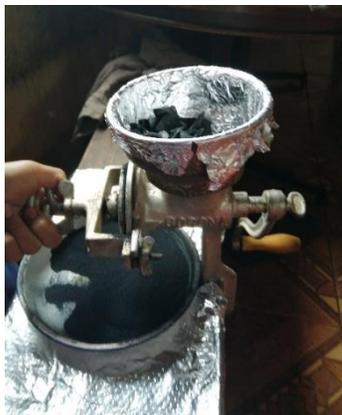
**Figura 12-2:** Molino usado para reducir el tamaño del carbón.
