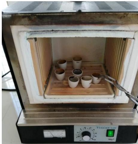
**Figura 14-2:** Mufla con crisoles para análisis de ceniza
