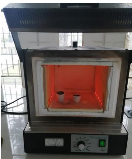
**Figura 15-2:** Mufla a 950 °C con crisoles
