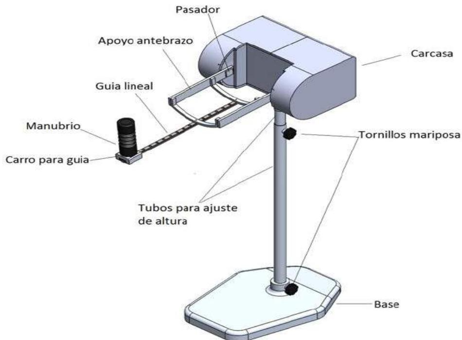
**Figura 2 - 2.** Rehabilitador pasivo de codo
