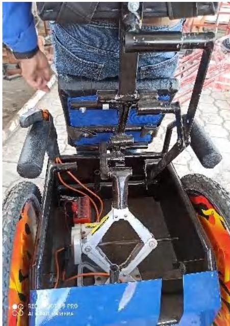
c) Detalle del acople del gato mecánico eléctrico a la estructura
