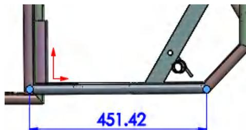
**Figura 15-3:** Vigas longitudinales inferiores
