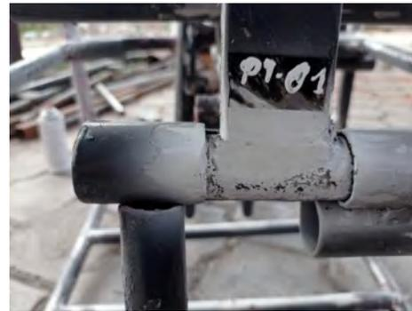
b) Detalle de la aplicación de la tinta en el cordón de soldadura
