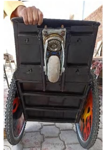
d) Detalle de la estructura inferior y montaje de la llanta delantera
