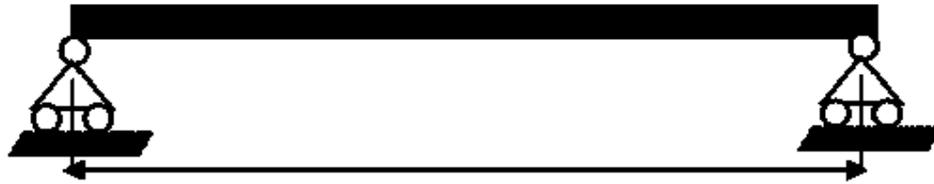
**Figura 17-3:** D.C.L. Correspondiente a las vigas longitudinales y transversales
