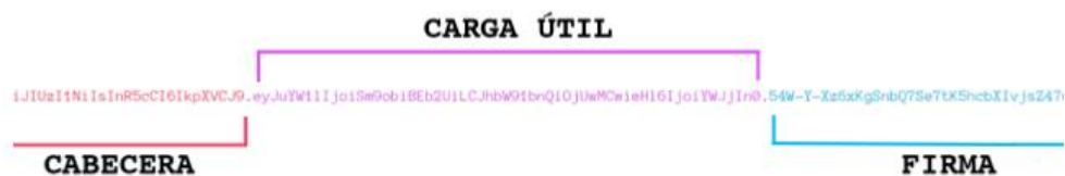
Figura 4-3. Estructura de un JSON Web Token
