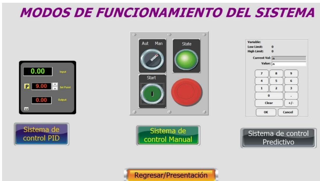
**Figura 46-5** Pantalla de elección de modos de funcionamiento
