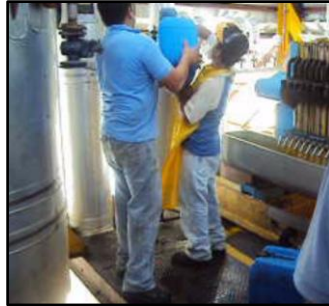
Figura 82. A sistencia en la dosificación de ácido fosfórico sin protección personal.
