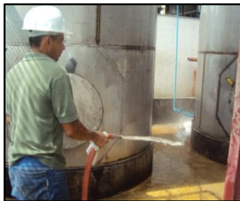
Figura 92. Falta de EPI's para contacto con superficies calientes.
