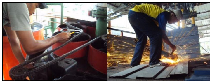
Cristalizador desprotegido. Amoladora desprotegida.
