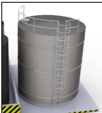
Figura 132. Tanque de ácidos grasos con el acceso seguro propuesto.
