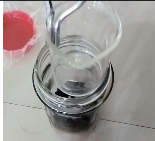
F14. Ingreso a la cámara de la solución captadora (0.1M) para análisis.
