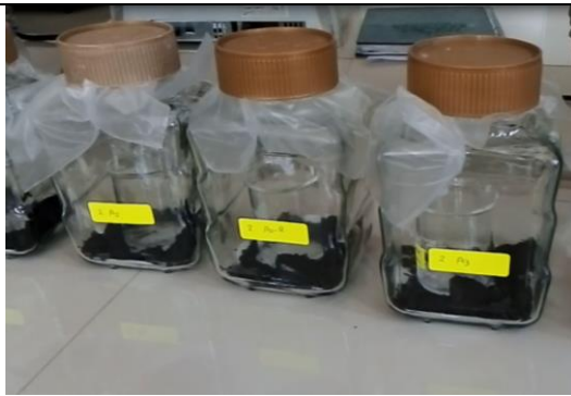
F9. cámaras de pre incubación hermetizadas y etiquetadas
