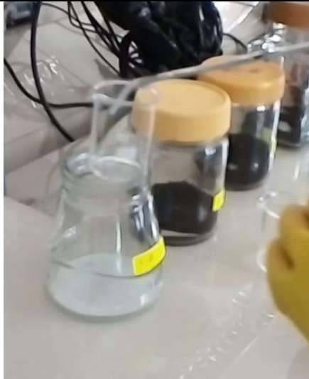
F7. Ingreso de la solución captadora concentrada a la cámara de pre incubación-blanco
