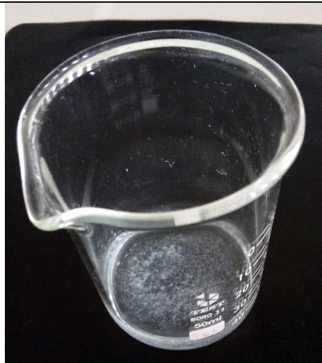
F22. Solución captadora para análisis con cloruro de bario (formación de precipitado blanco insoluble de carbonato de bario)
