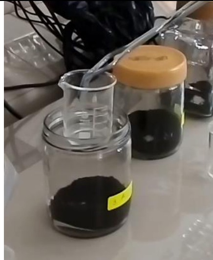
F8. Ingreso de la solución captadora concentrada a la cámara de pre incubación-muestra
