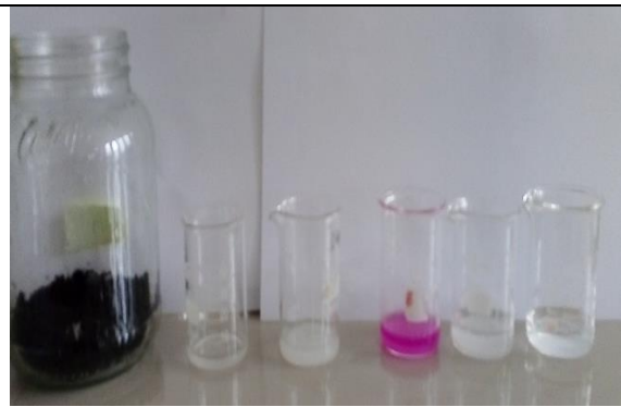
F26. Resumen de cambios de color durante la cuantificación: de izquierda a derecha: cámara con la muestra, solución captadora, solución captadora con cloruro de bario, solución captadora con cloruro de bario y Fenolftaleína, solución captadora titulada con HCl patrón secundario y finalmente solución titulada después de 5 min en reposo (todo el carbonato de bario precipitado).
