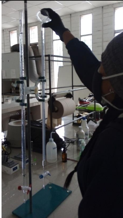
F19. Llenado de buretas con la solución de titulante estandarizado (bureta izquierda) y cloruro de bario (bureta derecha)
