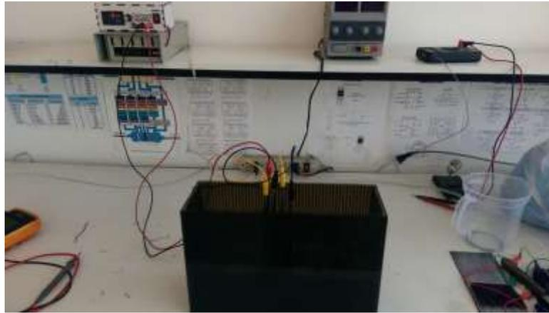
**Figura 1-3:** Equipo para la electrocoagulación
