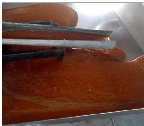
Figura 5-3: Batido de la panela
