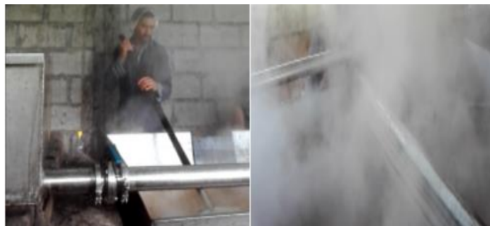
Figura 3-3: Evaporado del jugo de caña
