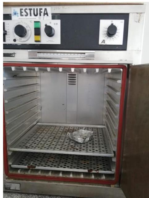
**Figura 2-7.** Secado de la muestra
