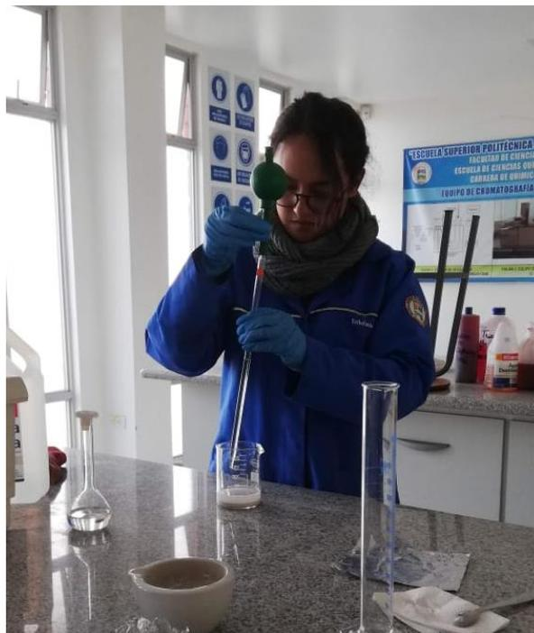
**Figura 2-8.** Adición de ácido acético a la muestra
