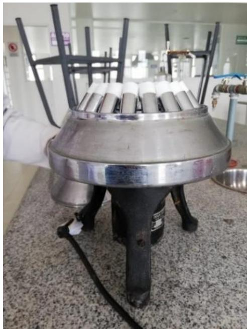
**Figura 2-10.** Centrifugación de la muestra
