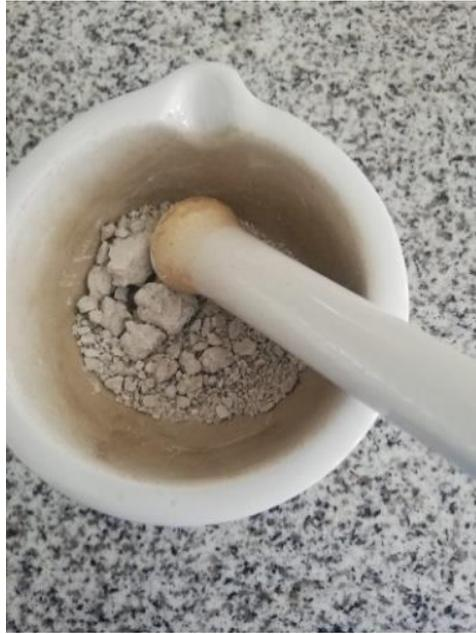
**Figura 2-5.** Disgregación de muestra
