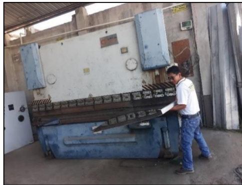
Figura 10-3: Trabajos en la dobladora electrohidráulica
