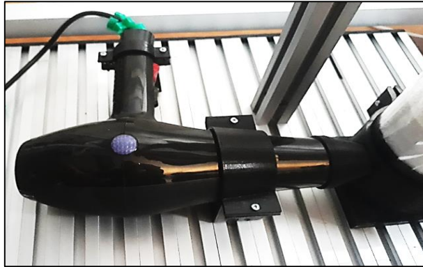
Figura 6-3: Ensamblaje del blower en la base de la estructura
