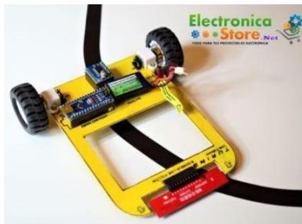
**Figura 4-2.** Robot seguidor de línea Turing
