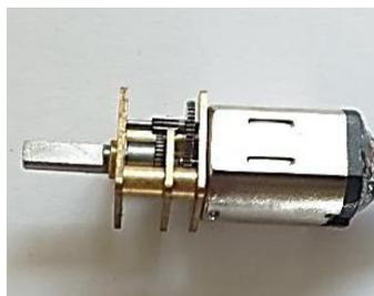
**Figura 33-3.** Micromotor metálico 10:1 Pololu
