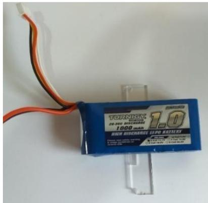
**Figura 29-3.** Batería lipo 3S 11,1V
