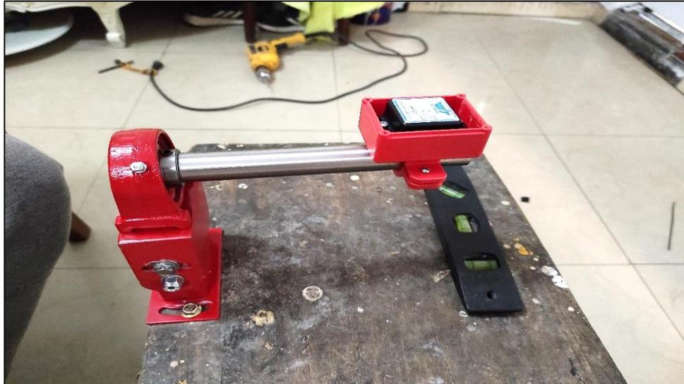
**Figura 2-3.** Comportamiento del sensor WT901BLECL sobre el eje de pruebas.
