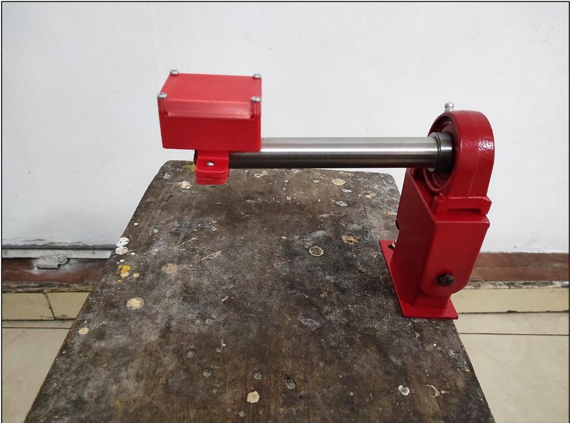
**Figura 2.** Eje de pruebas para los sensores ADXL335 Y WT901BLECL
