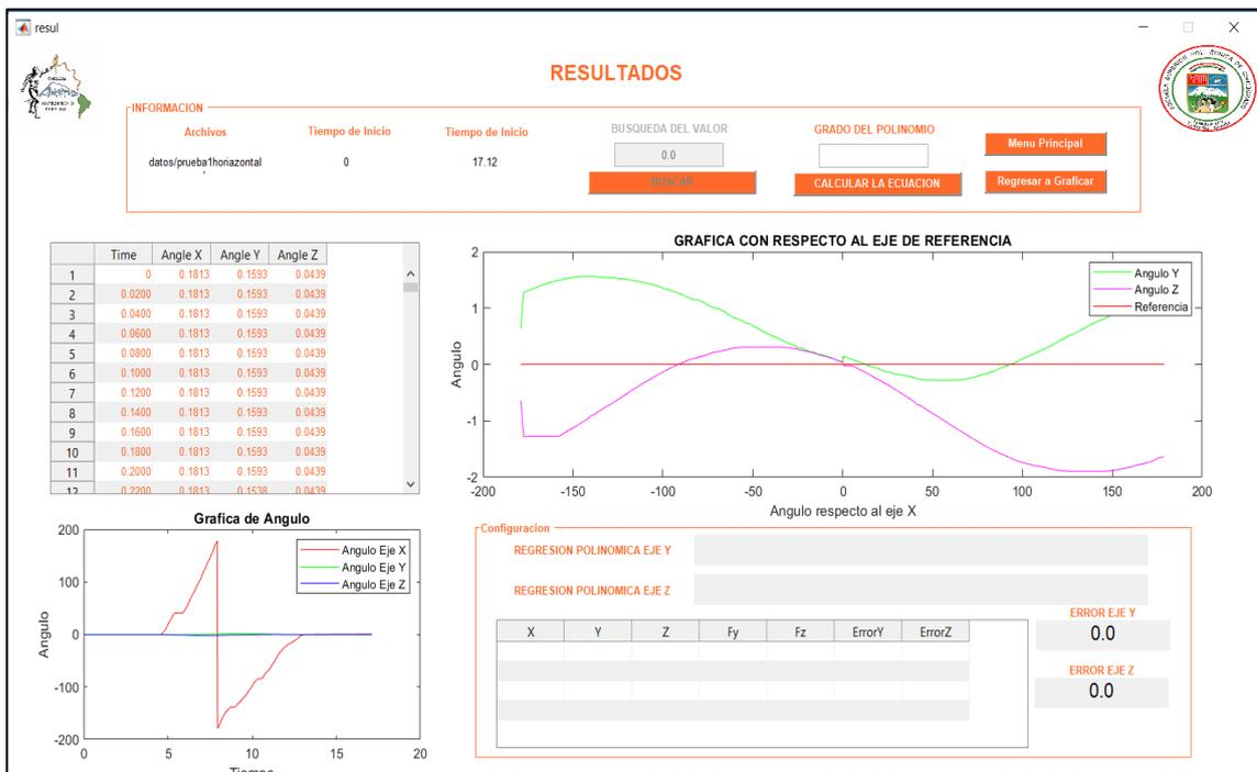
**Gráfico 7-3.** Gráfica con respecto al eje de referencia y de ángulo vs. tiempo de la primera prueba del sensor WT901BLECL.
