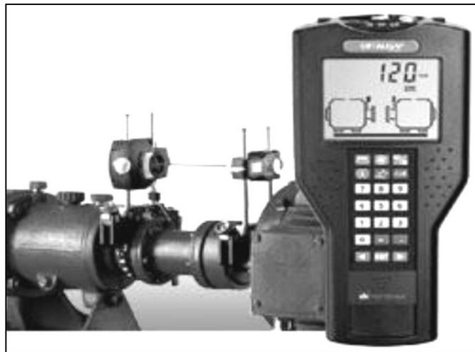
**Figura 28-1.** Método de alineación láser.
