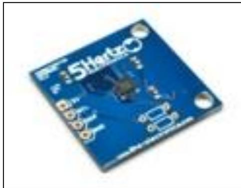
**Figura 16-1.** Magnetómetro vectorial.
