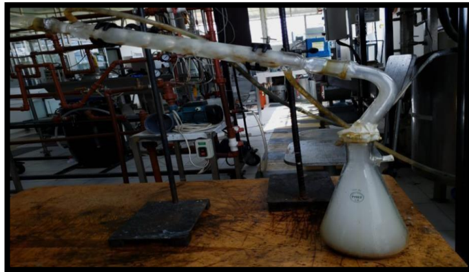
Figura 5-3: Fracción gaseosa de la degradación térmica de PP, PS y PET
