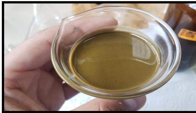
Figura 1-3: Fracción líquida de la degradación térmica
