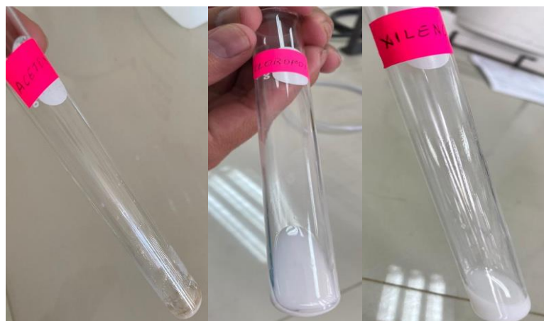
Figura 2-3: Prueba cualitativa de densidad del PS
