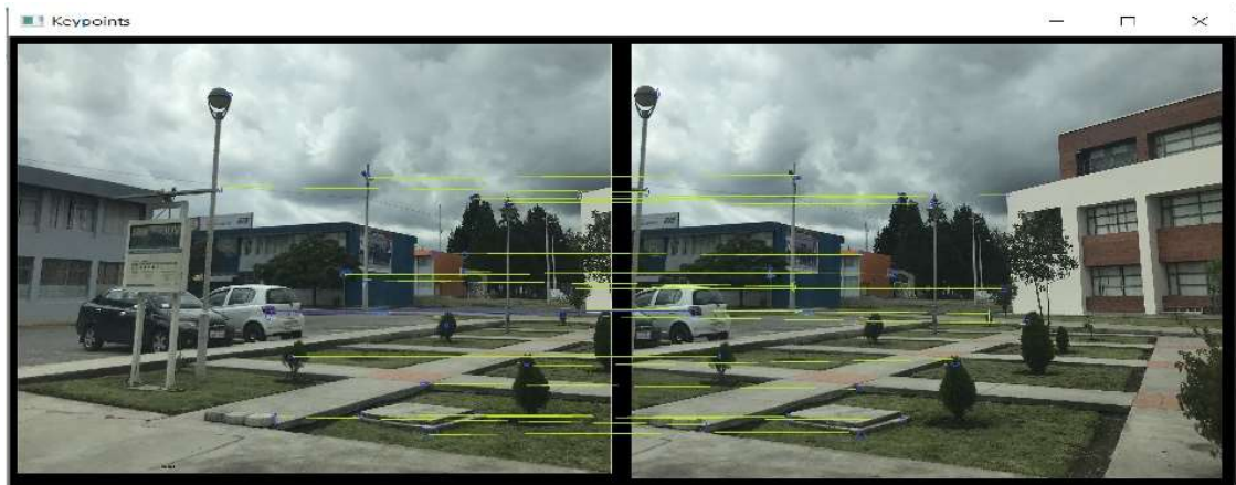
Figura 7-5: Keypoints de cámara 1 y cámara 2.
