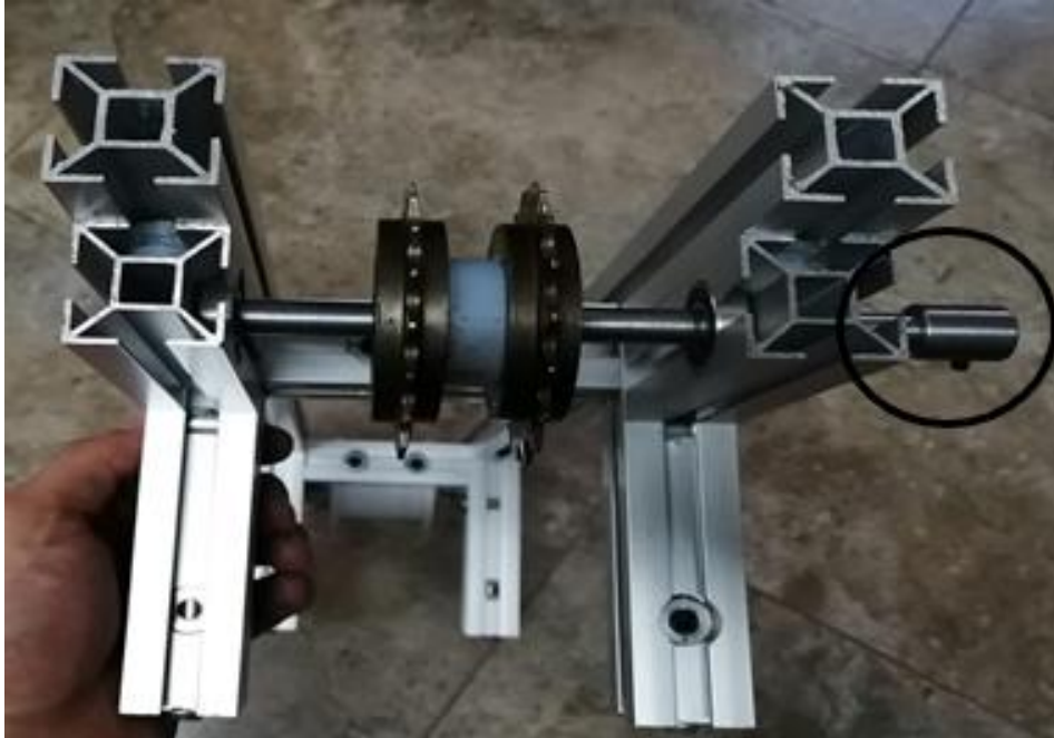
Figure 4-3: Eje para sistema de transmisión de movimiento del motor a la banda Realizado por: ROMÉRO, Patricio
