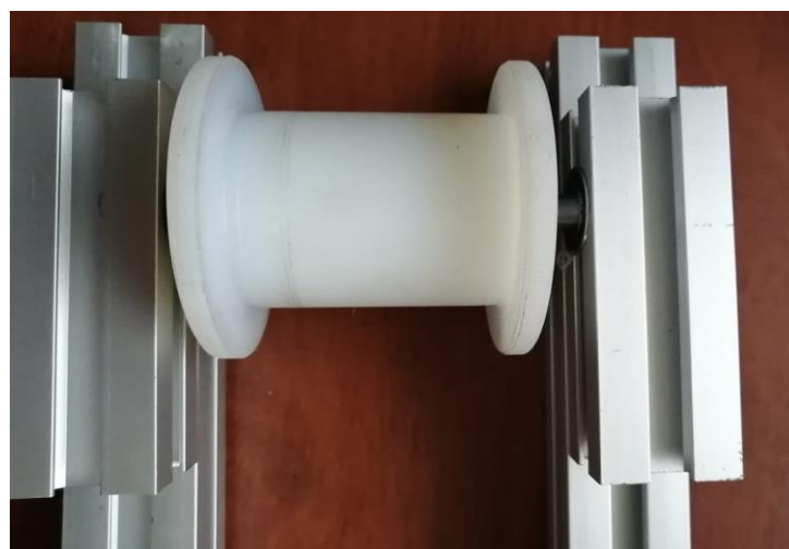
Figure 2-3: Sistema de ajuste para la banda eje conducido Realizado por: ROMERO, Patricio
