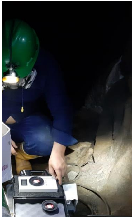
Figura 1B: Calibración de lector de electrets para posteriormente medir el Voltaje inicial
