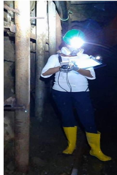
Figura 2A: Muestreo de campo con Geiger-Muller Realizado por: Liventon Yauli, 2020.
