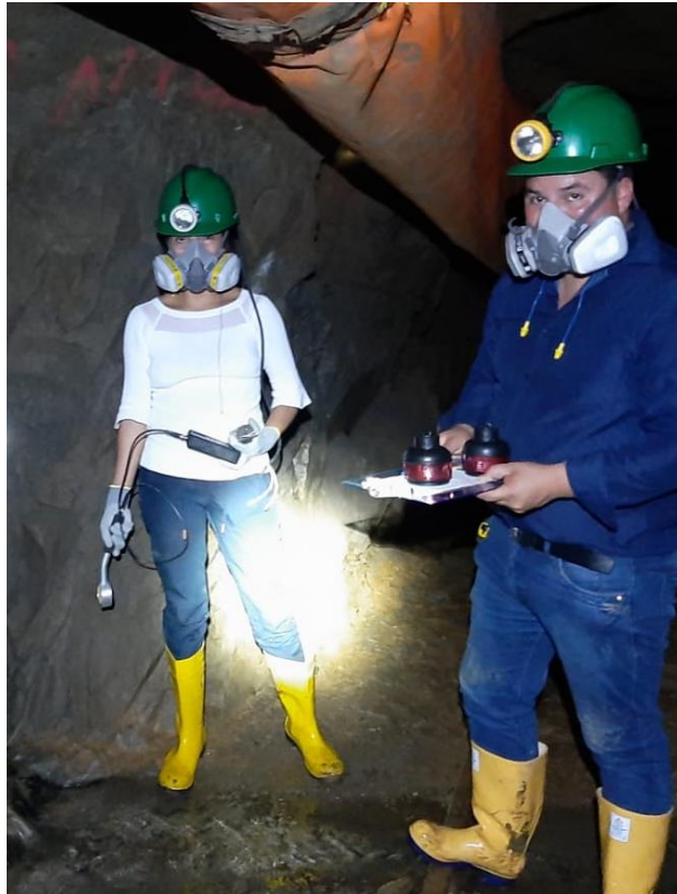
Figura 1C: Colocación de un par de cámaras S con sus respectivos electrets.
