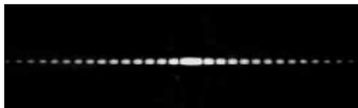
**Figura 4-1** Difracción de Fraunhofer de una sola rendija
