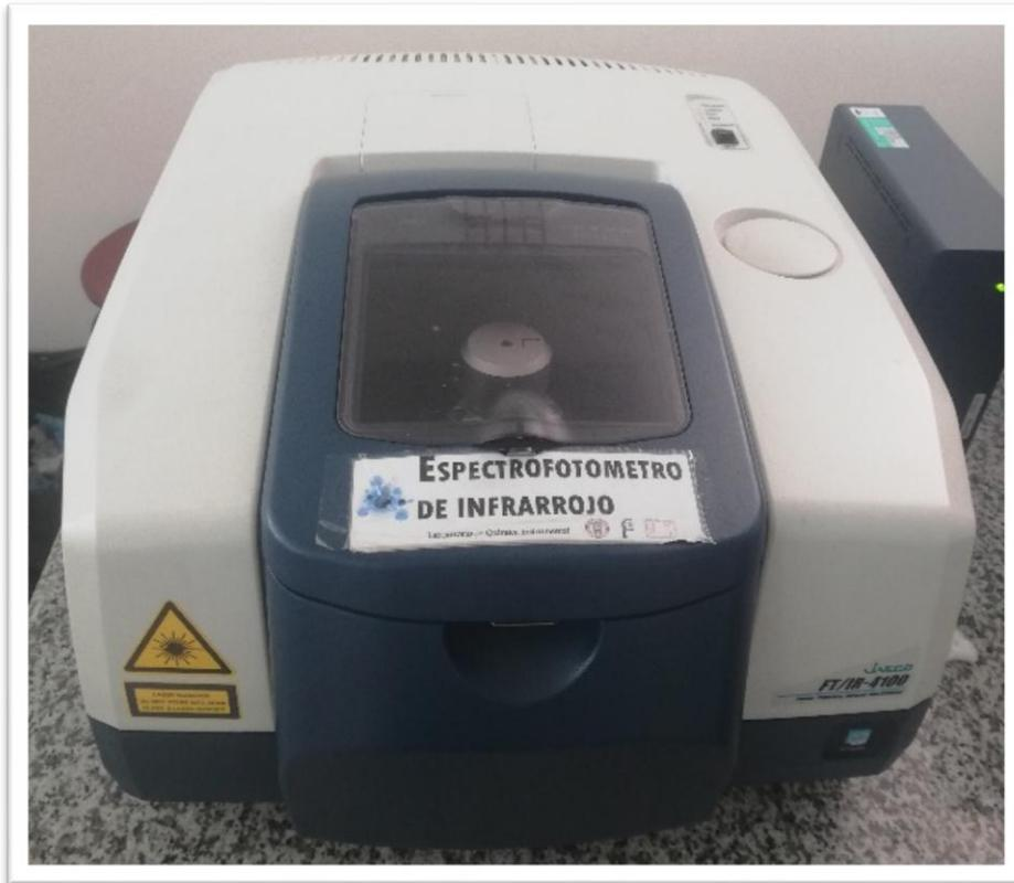
**Figura 3-2:** Espectrómetro de infrarrojo FT/IR-4700.
