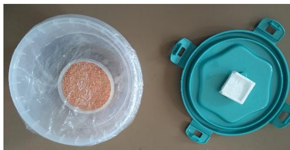
Figura 8-2: Cámara de difusión no estándar antes de ser sellada. Realizado por: Cantos, Ana, 2020
