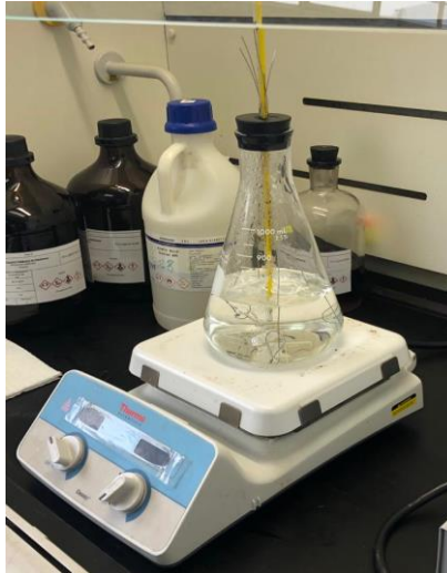
Figura 9-2: Configuración experimental para realizar el baño químico de los detectores CR-39. Realizado por: Cantos, Ana, 2020
