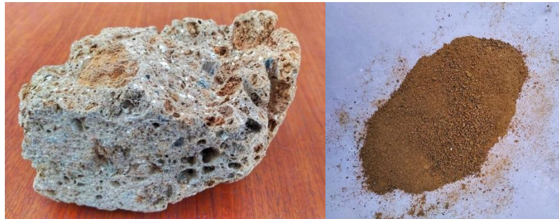
Figura 3-2: Izquierda: Tufo volcánico italiano (piedra entera). Derecha: Muestra triturada. Realizado por: Cantos, Ana, 2020
