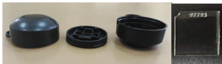
Figura 2-2: Sistema de detección, Izquierda: Cámara estándar. Derecha: Detector CR-39. Realizado por: Cantos, Ana, 2020
