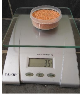
Figura 4-2: Pesaje de la muestra de zanahoria de granulometría 3mm.
