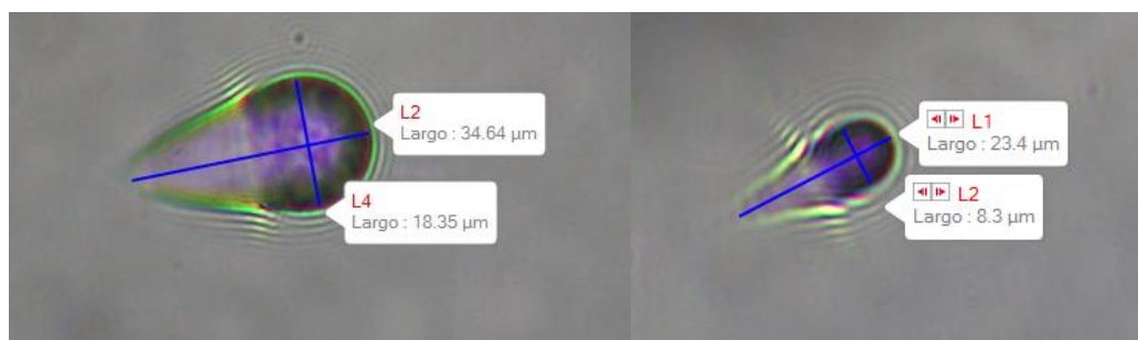
Figura 6-3: Trazas nucleares de forma ovoide.
