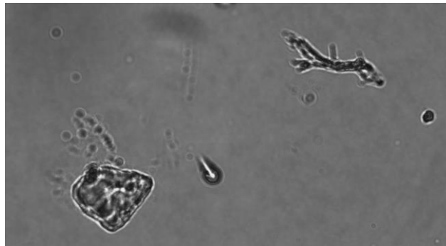
Figura 8-3: Defectos propios de fábrica de los detectores CR-39. Realizado por: Cantos, Ana, 2021.
