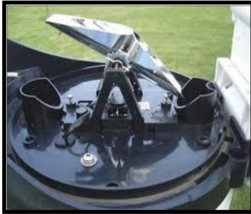
Figura 4-1: Pluviógrafo de doble cubeta basculante Fuente: (RiegoLariñoCarlota.pdf, s. f.).
