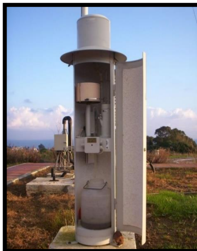
Figura 3-1: Pluviógrafo de sifón
