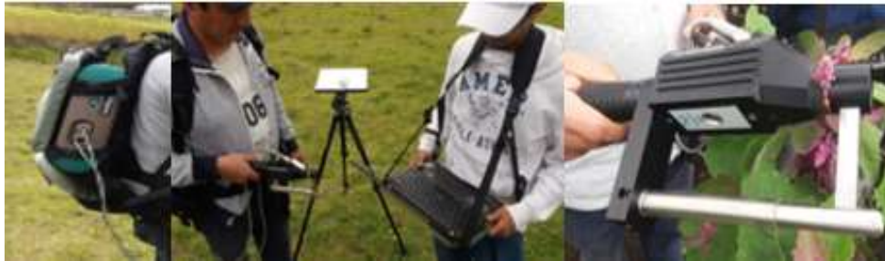
Figura 5-2: Recolección de espectros utilizando el Espectroradiómetro ASD FieldSpec4
