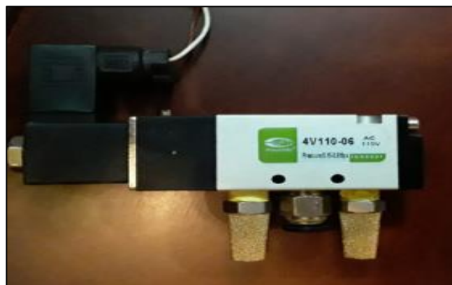
Figura 8-2. Válvula distribuidora 5/2 de bobina simple. Fuente: Bonifaz, J., Quezada, A., 2020
