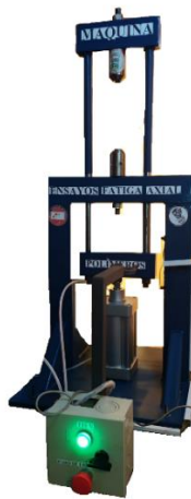
Fig 1. Máquina de fatiga de polímeros
