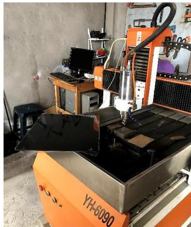
**Figura 43-3:** Montaje de placa de fibra de carbono en Router CNC
