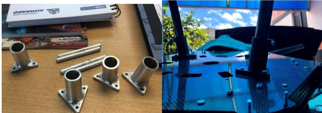
**Figura 47-3:** Instalación de soportes de tren de aterrizaje
