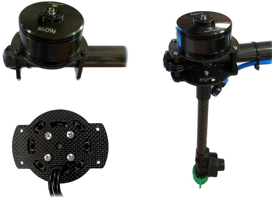
**Figura 55-3:** Motor montado en soporte superior y aspersor montado en soporte inferior
