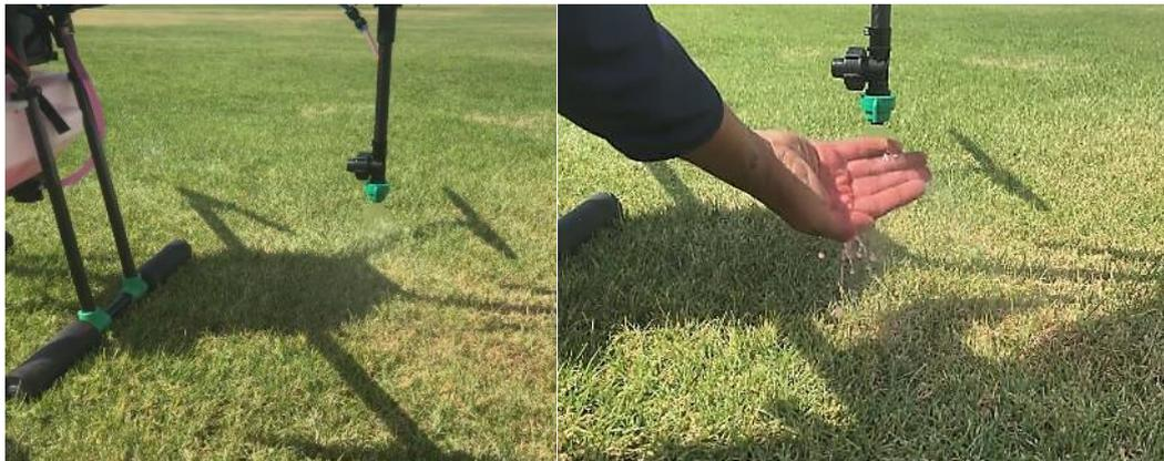
**Figura 5-4:** Aspersores activados, muestra del espectro de riego .
