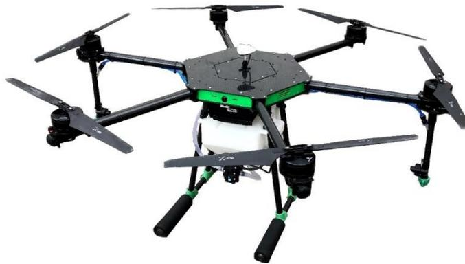
**Figura 64-3:** Armado completo de la nave Wayra A-1
