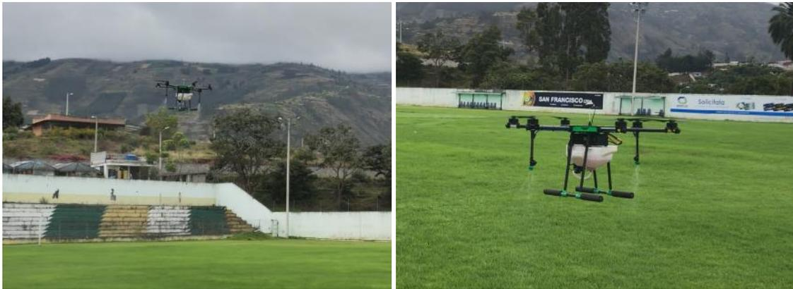
**Figura 8-4:** Prueba vuelo con accionamiento de riego
