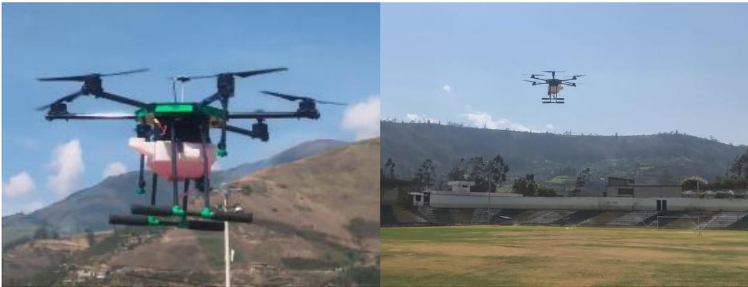
**Figura 4-4:** Prueba vuelo con movimientos laterales con 2 Kg de carga útil.
