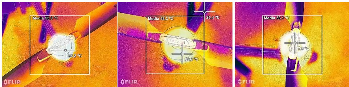
**Figura 13-4:** Termografías de cada motor después de prueba con carga.
