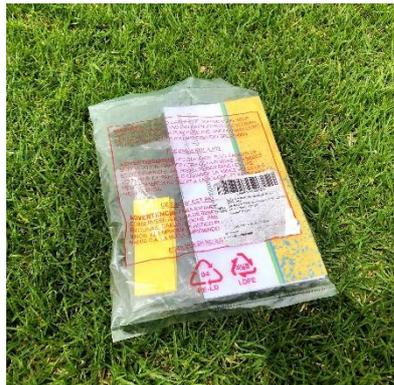
**Figura 15-4:** Papeles hidro sensibles para pruebas en campo
