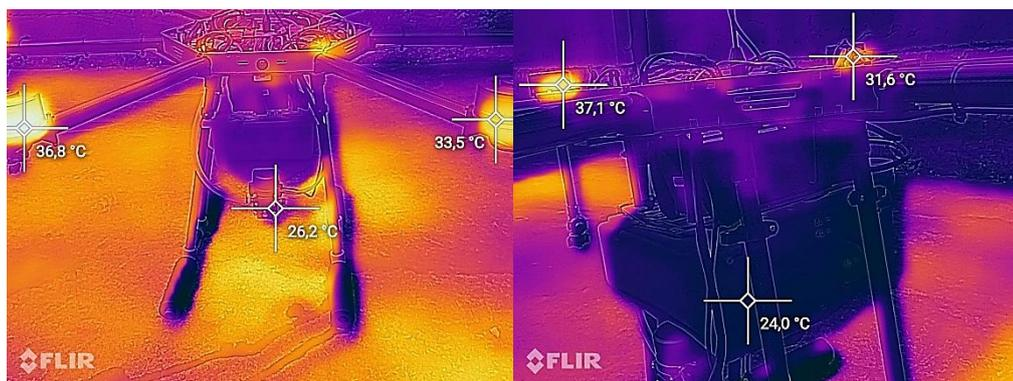
**Figura 14-4:** Termografías de la bomba, batería y tanque de agua con marcadores
