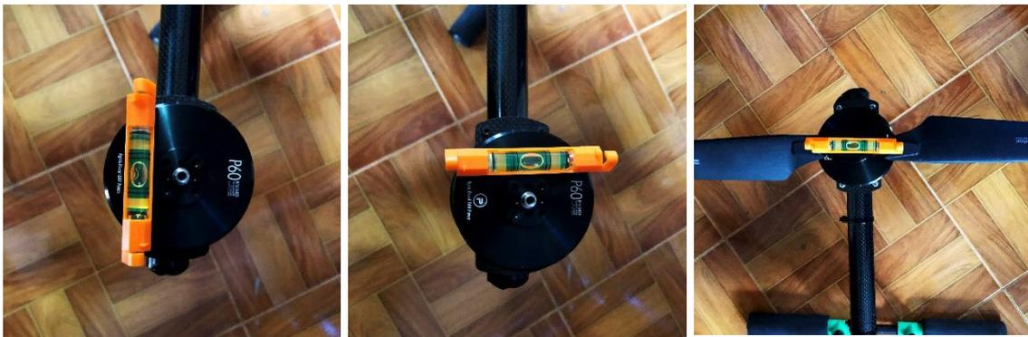
**Figura 62-3:** Calibración y nivelación de motores
