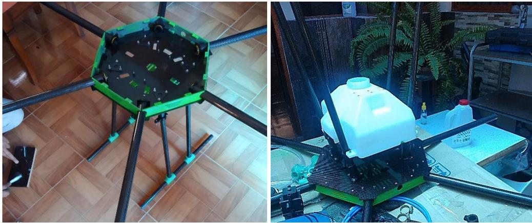
**Figura 51-3:** Ensamblaje del sistema de aterrizaje y sujeción del tanque de alimentación
