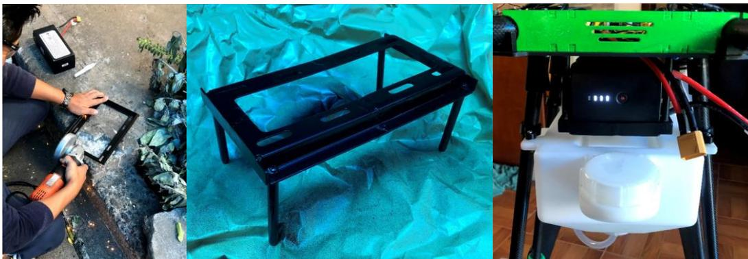
**Figura 52-3:** Construcción y montaje de la placa de sujeción de batería
