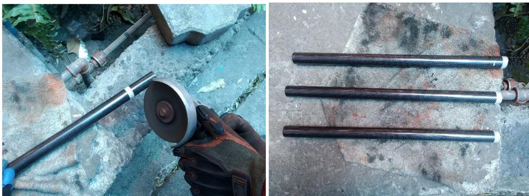
**Figura 48-3:** Medición y corte de tubos de fibra de carbono
