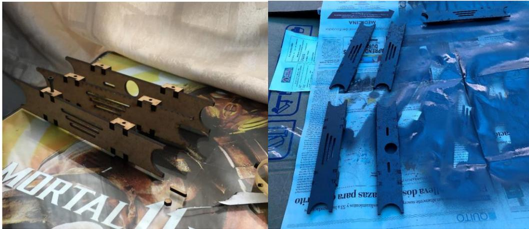
**Figura 49-3:** Armado y aplicación de capa sellante de poliuretano a tapas laterales
