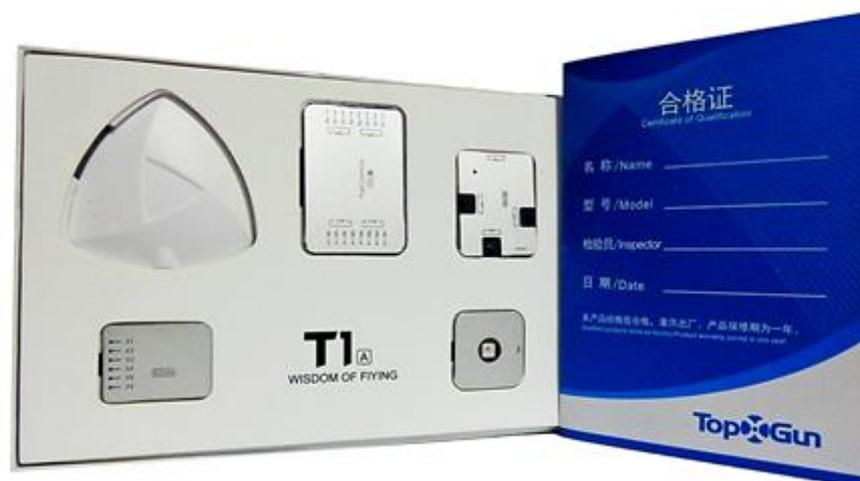
**Figura 34-3:** Tarjeta controladora de uso agrícola TopXGun T1-A
