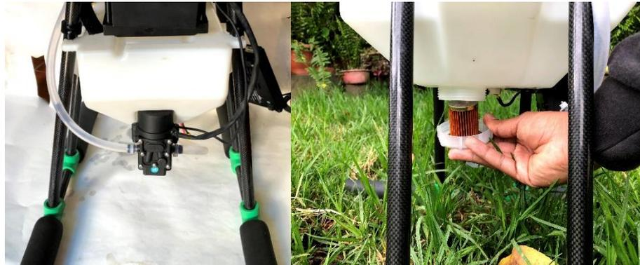
**Figura 53-3:** Instalación de filtro y sensor de nivel en el tanque
