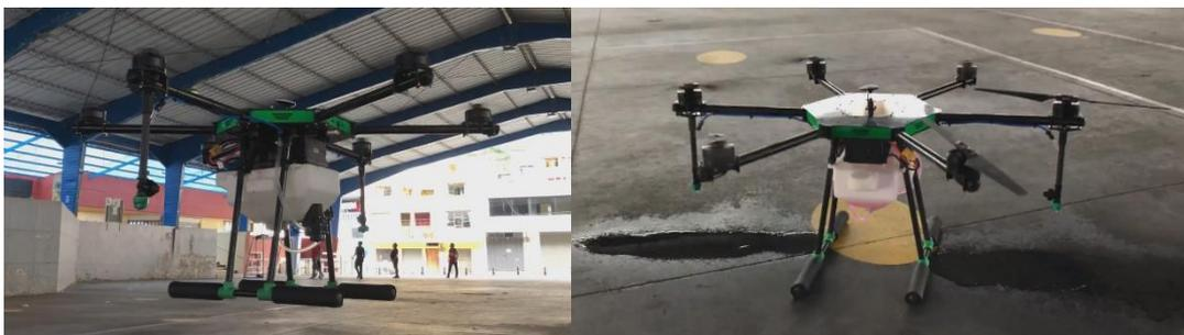
**Figura 3-4:** Prueba vuelo con movimientos de elevación y encendido de aspersores
