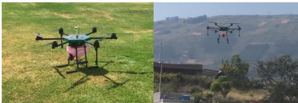
**Figura 6-4:** Prueba vuelo con movimientos de desplazamiento con 5 Kg de carga útil.
