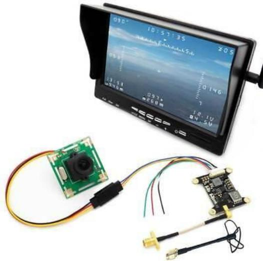
**Figura 27-2:** Sistema FPV con pantalla a externa
