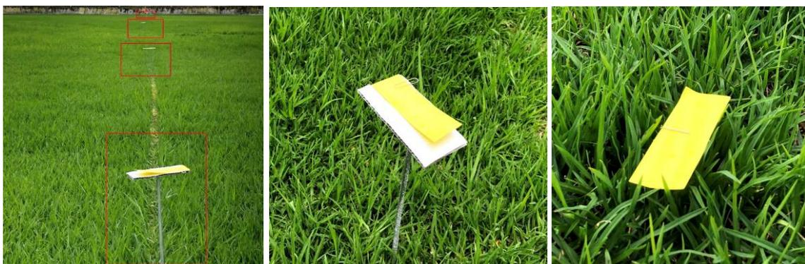
**Figura 16-4:** Ubicación de papeles hidro sensibles en clavijas y a ras de suelo prueba en campo
