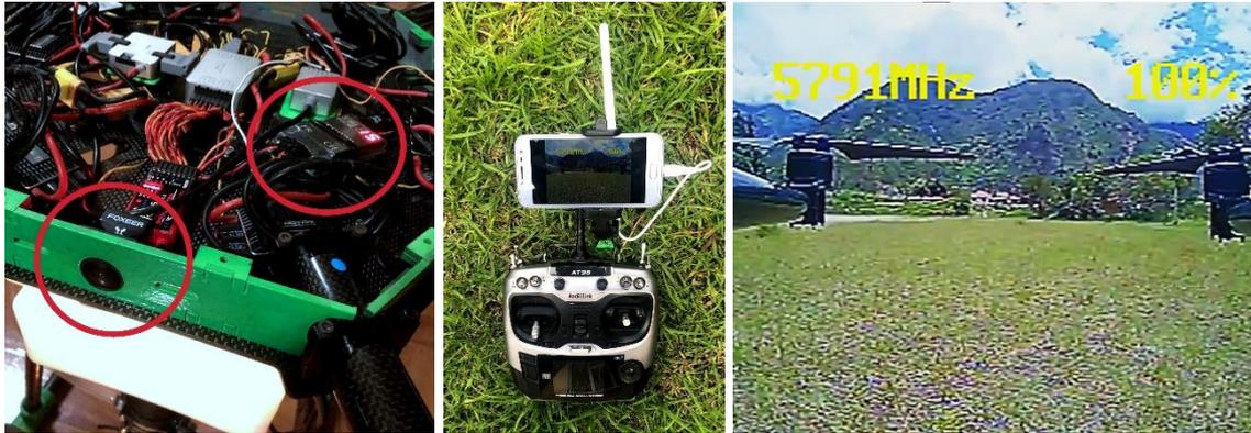
**Figura 59-3:** Sistema de transmisión y recepción de video
