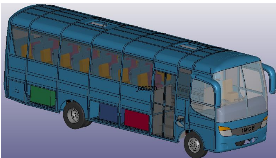
Figura 4-3. Centro de gravedad, expresado en mm (autobús con equipaje y pasajeros) Realizado por: Salinas Robalino, G., 2020
