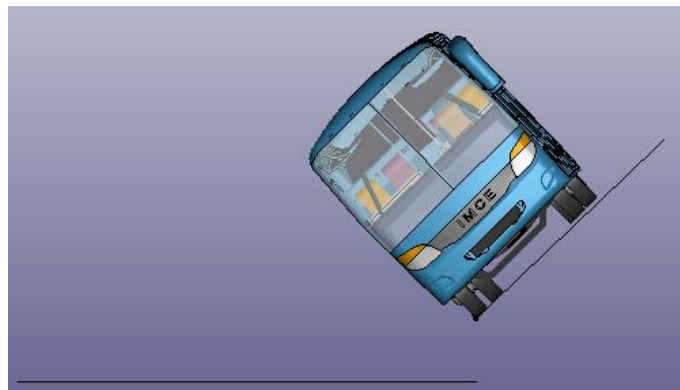
Figura 7-3. Equilibrio inestable ( t=9.45s ) Realizado por: Salinas Robalino, G., 2020
