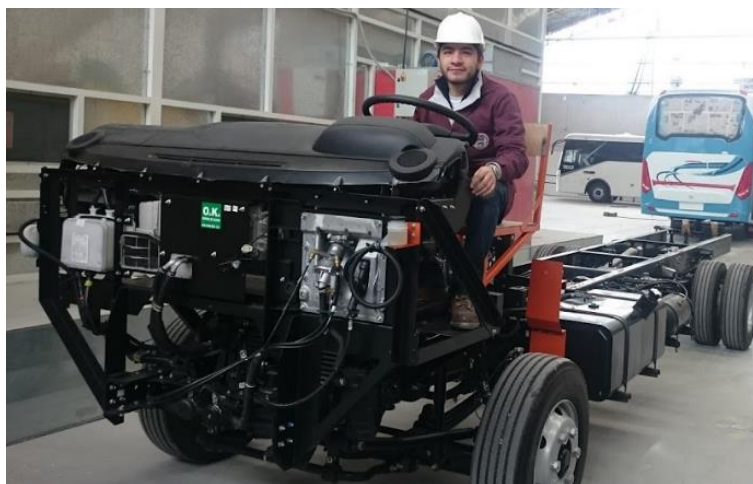
Figura 10-1. Chasis Hino FC9J (chasis tipo ladder) Realizado por: Salinas Robalino, G., 2020
