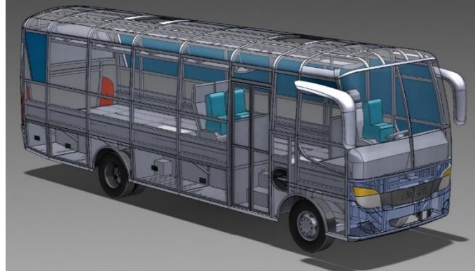
Figura 8-2. Minibús generado por medio de CAD Realizado por: Salinas Robalino, G., 2020
