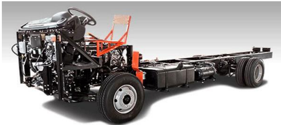
Figura 7-2. Chasis Hino FC9J homologado para minibús Fuente: (Teojama Comercial S.A., 2017) Realizado por: Salinas Robalino, G., 2020
