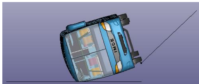
Figura 8-3. Impacto de la estructura ( t=10.8s ) Realizado por: Salinas Robalino, G., 2020
