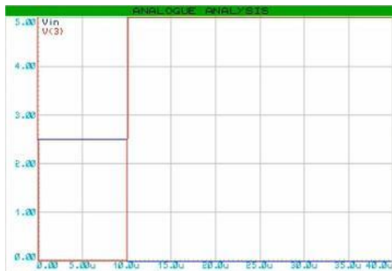
Figura 21 – 3. Comportamiento a la salida del monoestable (sin filtro)
