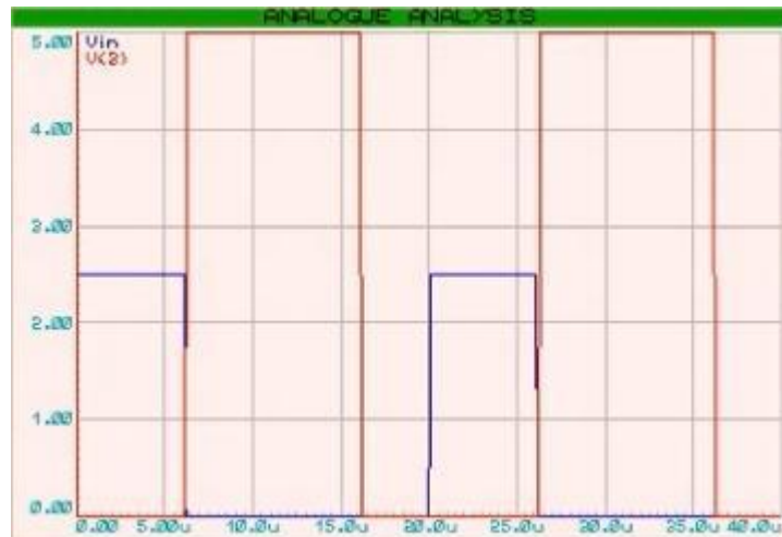
Figura 23 – 3. Salida del monoestable (50% de la frecuencia)
