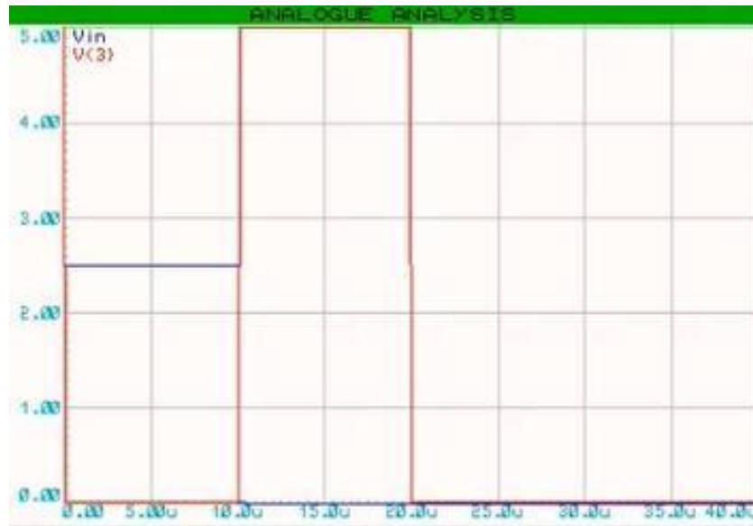
Figura 18 – 3. Comportamiento a la salida del monoestable (señal digital)
