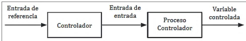
**Figura 14-2:** Sistema de control a lazo abierto.
