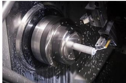
Figura 5-2. Proceso de torneado
