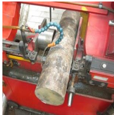
Figura 21-3. Corte del eje acero AISI 5115
