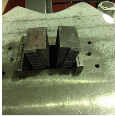
Figura 30-3. Colocación de las mordazas
