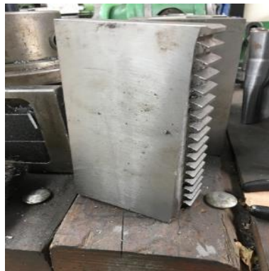
Figura 25-3. Forma final de la cremallera
