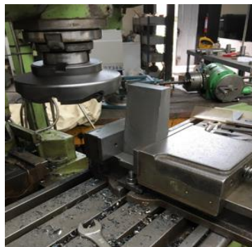
Figura 23-3. Mecanizando la forma básica de la muela
