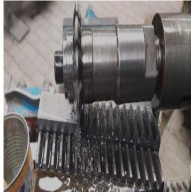
Figura 24-3. Mecanizado de la cremallera
