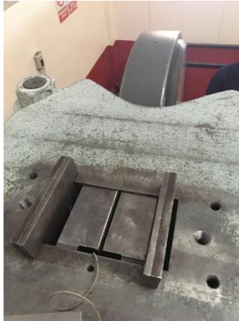
Figura 32-3. Colocación interna de las mordazas
