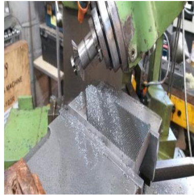
Figura 26-3. Mecanizado zona rugosa a 71°
