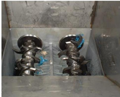
**Figura 9-2:** Trituradora de Cuchillas
