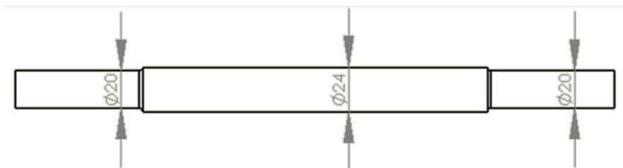
**Figura 18-3:** Dimensionamiento del eje.
