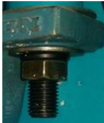
Figura 11-3. Conjunto pernos, tuerca, arandela y arandela de presión.
