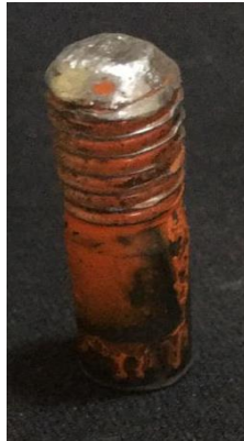
Figura 7-3. Pin del embrague desgastado.
