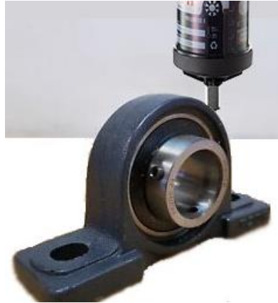
Figura 10-3. Lubricación de Chumacera NBR-P208.
