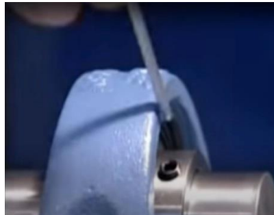
Figura 3-3. Prueba de ruido a los rodamientos.
