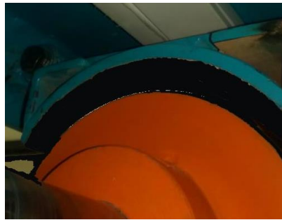
Figura 5-3. Zapata de fibra de carbono prueba de contra luz.
