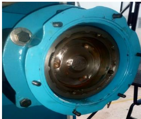
Figura 17-3. Acople hembra pulido y con pernos nuevos.
