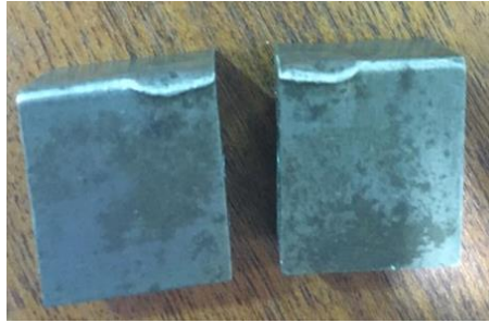
Figura 4-3. Apoyos de las probetas deteriorados.
