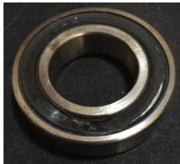
Figura 8-3. Rodamiento deteriorado del embrague.
