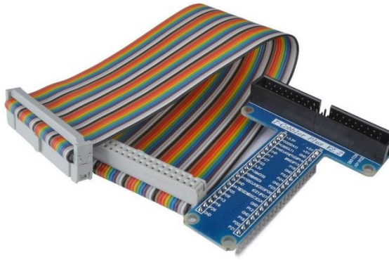
Figura 20-2. Extensor de conexión puertos GPIO.
