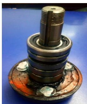
Figura 18-3. Acople macho con nuevos rodamientos.
