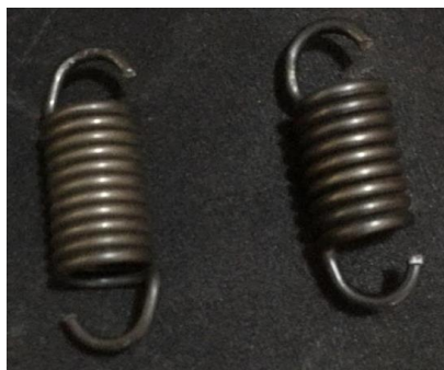
Figura 6-3. Muelle original y muelle nuevo.
