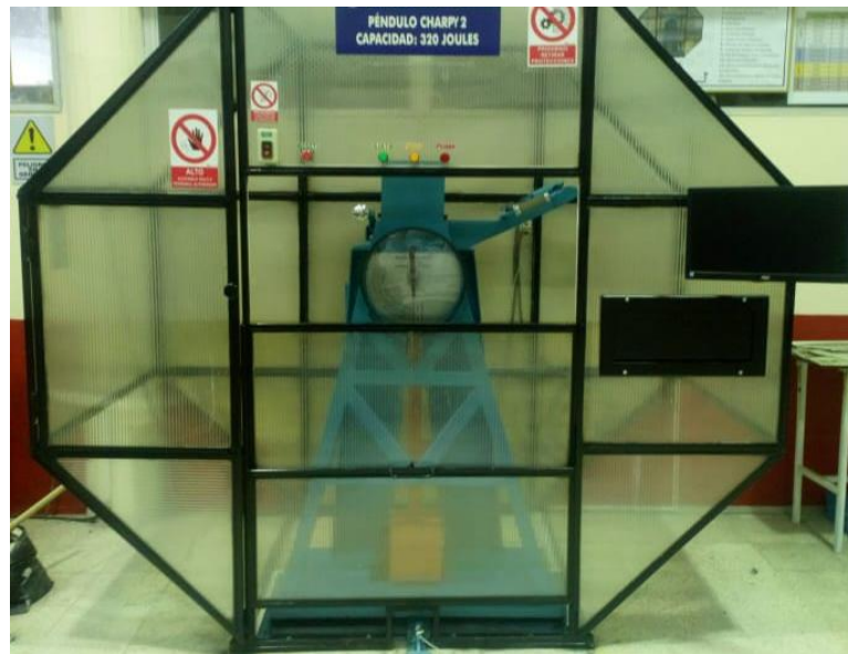
Figura 33-3. Carcasa protectora con los nuevos periféricos de entrada y salida.
