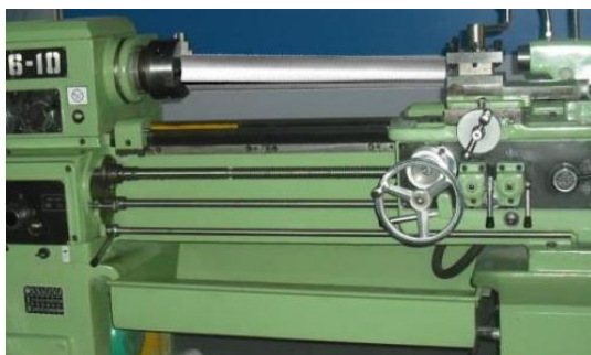
Figura 9-3. Eje en el torno centrado y preparado para el pulido.
