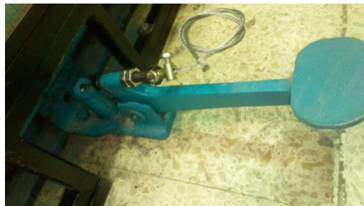
Figura 21-3. Perno de sujeción transversal en el pedal del freno.
