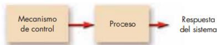
Figura 22-2. Sistema de lazo abierto.
