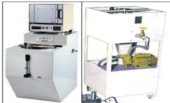
Figura 6-3. Máquinas de Templabilidad. a) REMET, b) UNIVERSAL MOTION.
