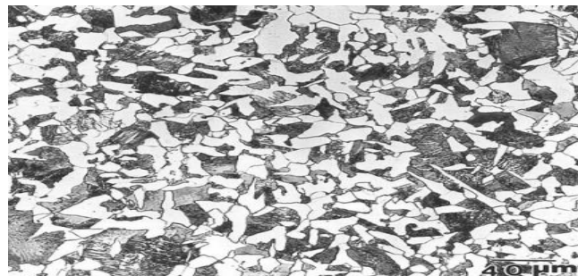
Figura 1-2. Acero medio en carbono SAE 1040. Muestra una matriz: ferrita (zonas blancas) y perlita (zonas oscuras). 300x
