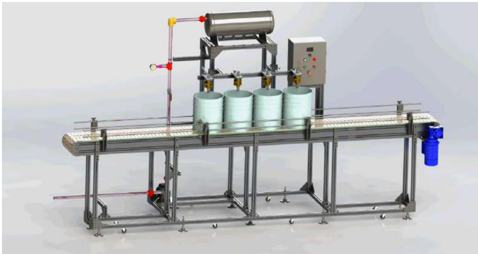
Figura 56-4. Simulación en SOLIDWORKS para el envase de 5 galones
