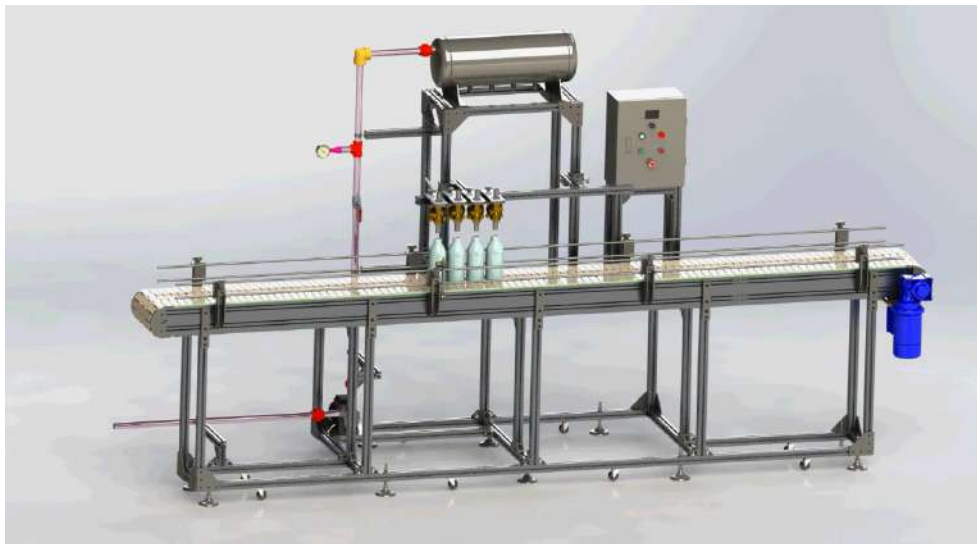
Figura 58-4. Simulación en SOLIDWORKS para el envase de 1 litro.
