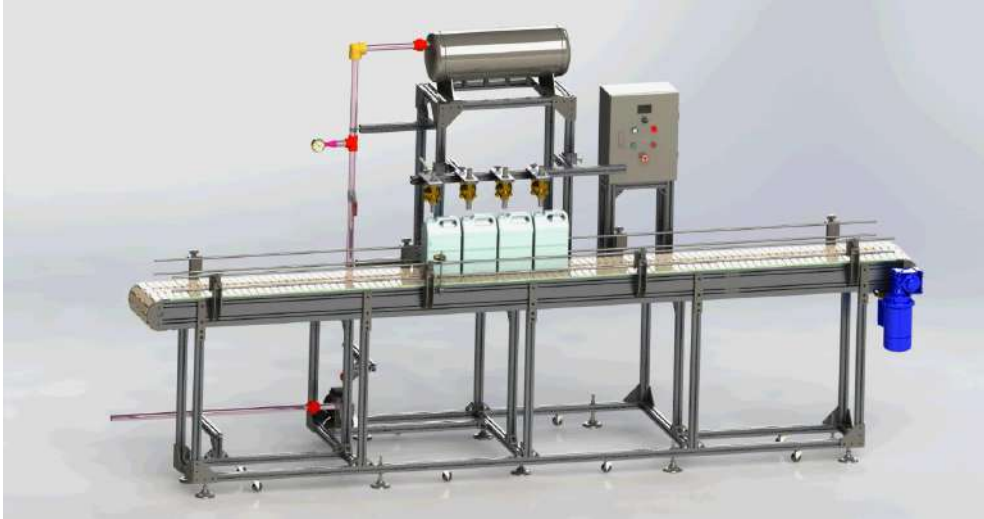
Figura 57-4. Simulación en SOLIDWORKS para el envase de 1 galón.
