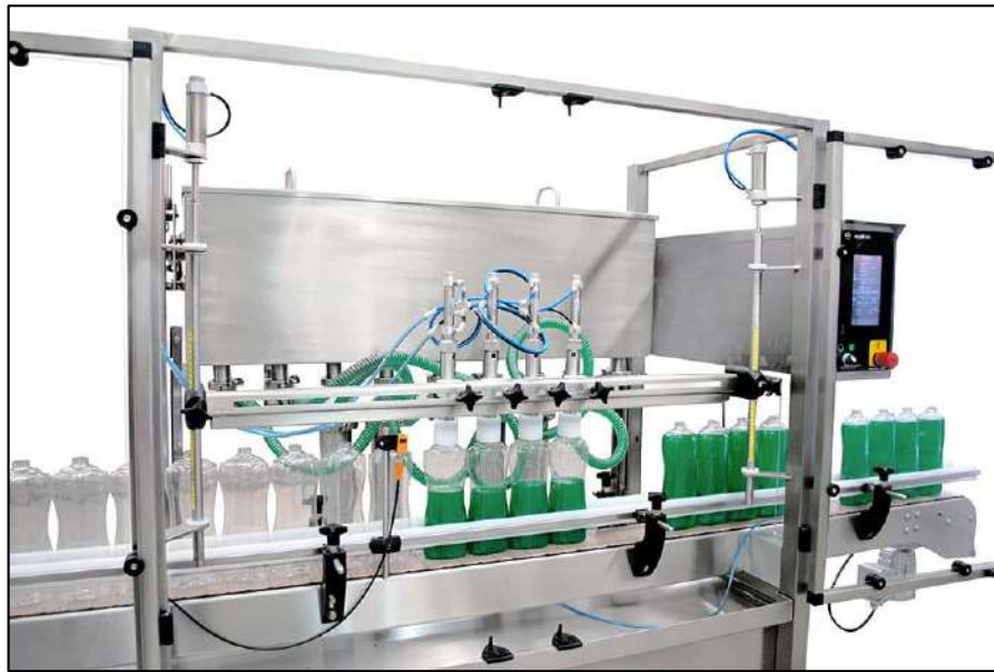
Figura 2-2. Envasadora de productos líquidos por nivel (EQUITEK)
