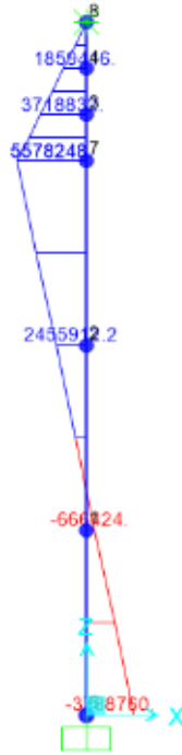
Figura 27-3: Diagrama de momentos flectores en la columna Realizado por: Cando Diego, García Nelson, 2020
