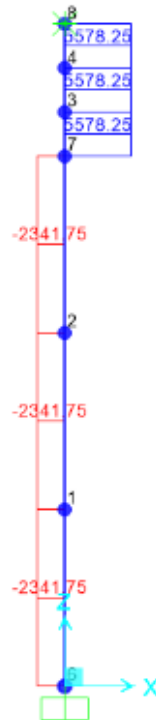
Figura 26-3: Diagrama de fuerzas cortantes en la columna Realizado por: Cando Diego, García Nelson, 2020
