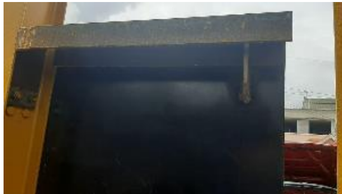
Figura 1-4: Refuerzos instalados en el impactador
