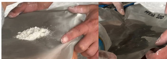
Figura 75-3. Ensayo de la diatomita desintegrada en malla 200
