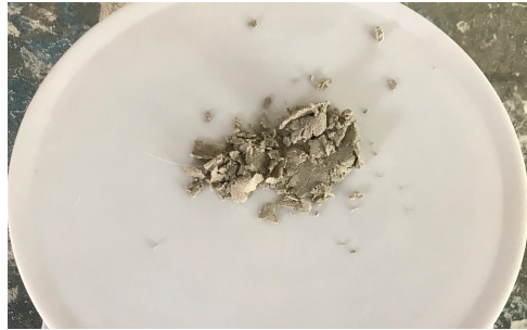
Figura 78-3. Impurezas retenidas por la malla 325
