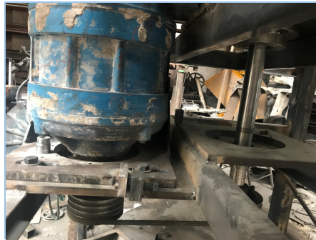
Figura 70-3. Adaptación del motor y rodamientos del molino
