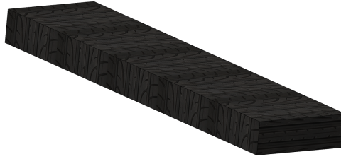
Figura 19-2. Fragmento de una banda plana
