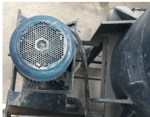
Figura 5-3. Conexión del motor al molino
