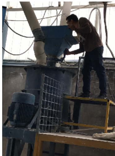
Figura 1-3. Molino para óxido de calcio
