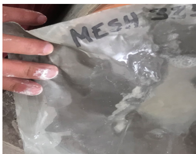
Figura 77-3. Ensayo de la diatomita desintegrada en la malla 325
