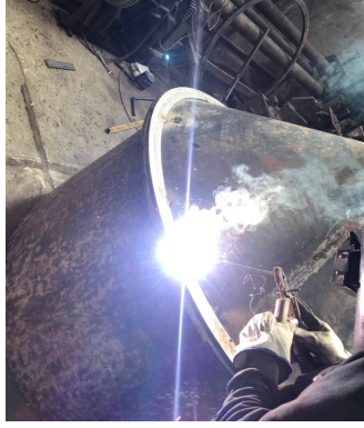
Figura 62-3. Unión y relleno del anillo y cono
