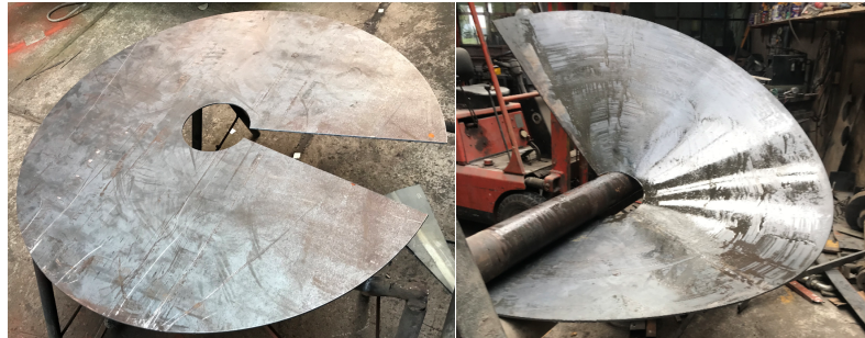
Figura 60-3. Medición, corte y doblado de los conos
