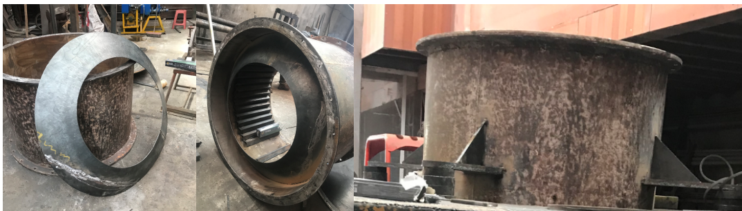
Figura 66-3. Acabado del tambor con sus elementos
