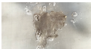
Figura 76-3. Impurezas retenidas por la malla 200
